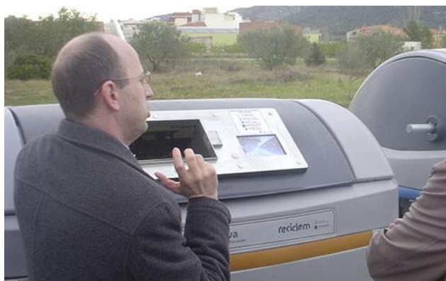
Figura 6. Contenedor de residuo doméstico con chip de identificación de usuario, utilizados en los municipios de Alcalà de Xivert y Alcossebre. Fuente: Tetma
