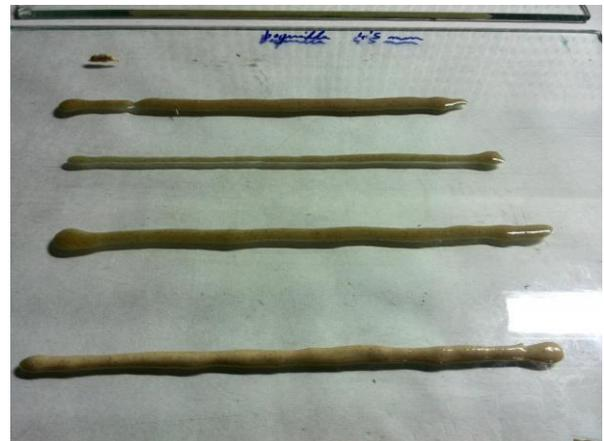
**Pruebas de aplicación mediante inyección de material con carga de madera.**
