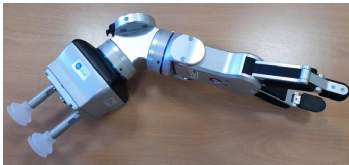
Garra doble para realizar recogida de piezas y de láminas
