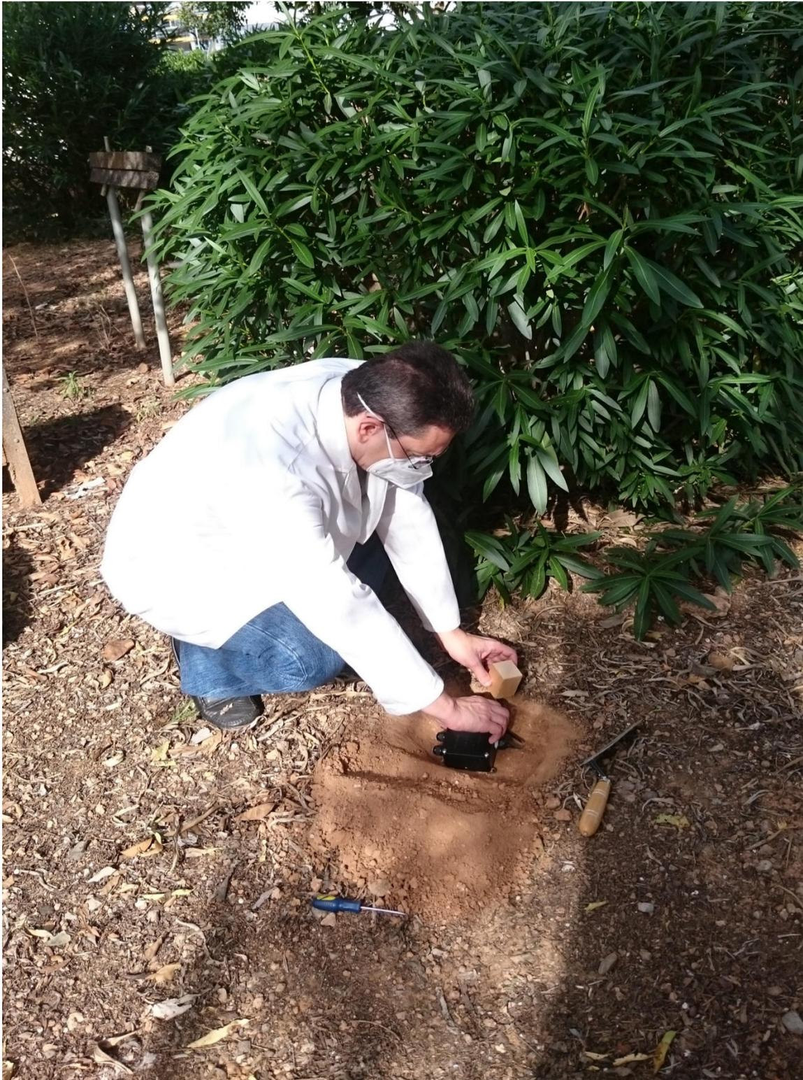
Imagen 48. Colocación del nodo sensor nº 3 en el agujero excavado.
