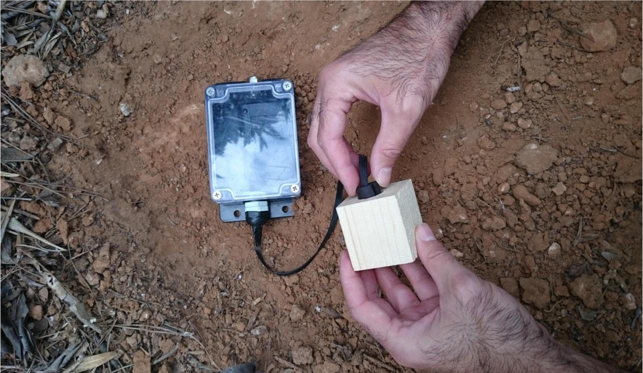
Imagen 44. Colocación del nodo sensor nº 7 en el agujero excavado. El bloque de madera clara y blanda, donde va insertado el módulo DIPP\_SENS del nodo sensor, actúa como cebo para las termitas.
