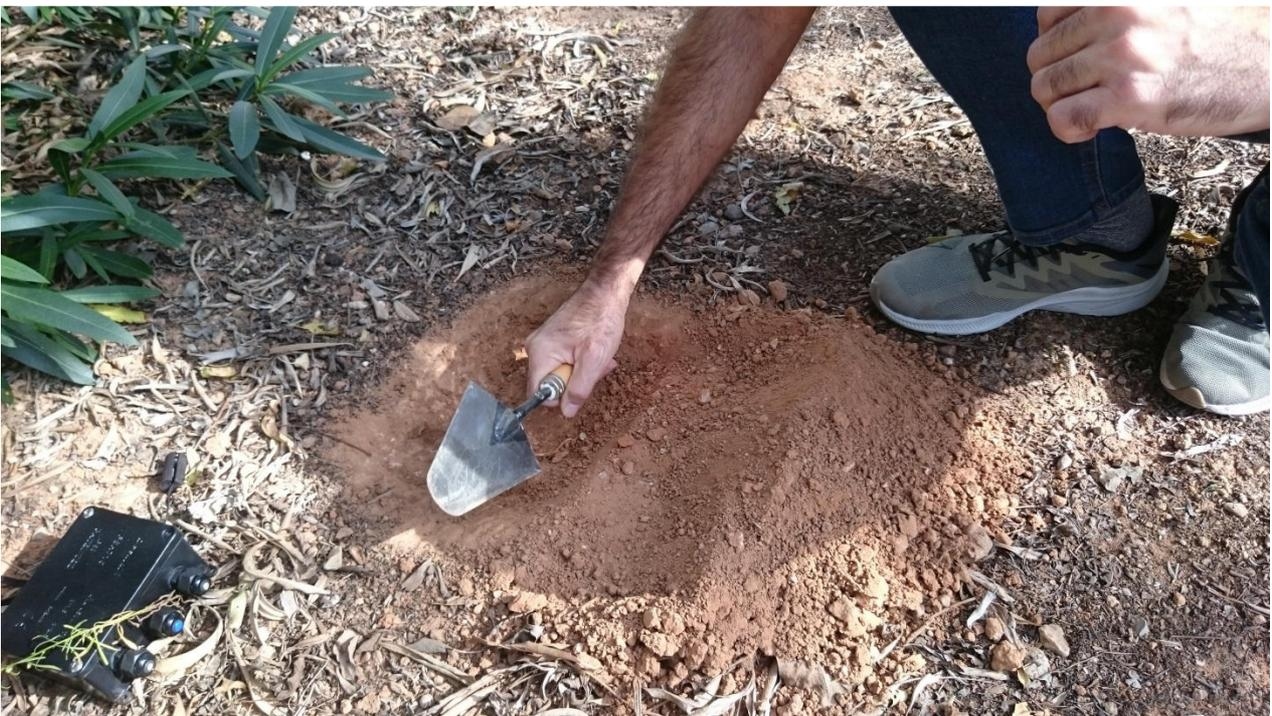
Imagen 47. Excavación del agujero para enterrar el nodo sensor nº 3.
