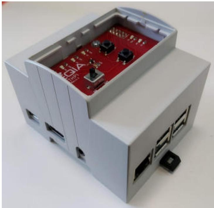
Imagen 22. Nodo receptor en caja de carril DIN.
