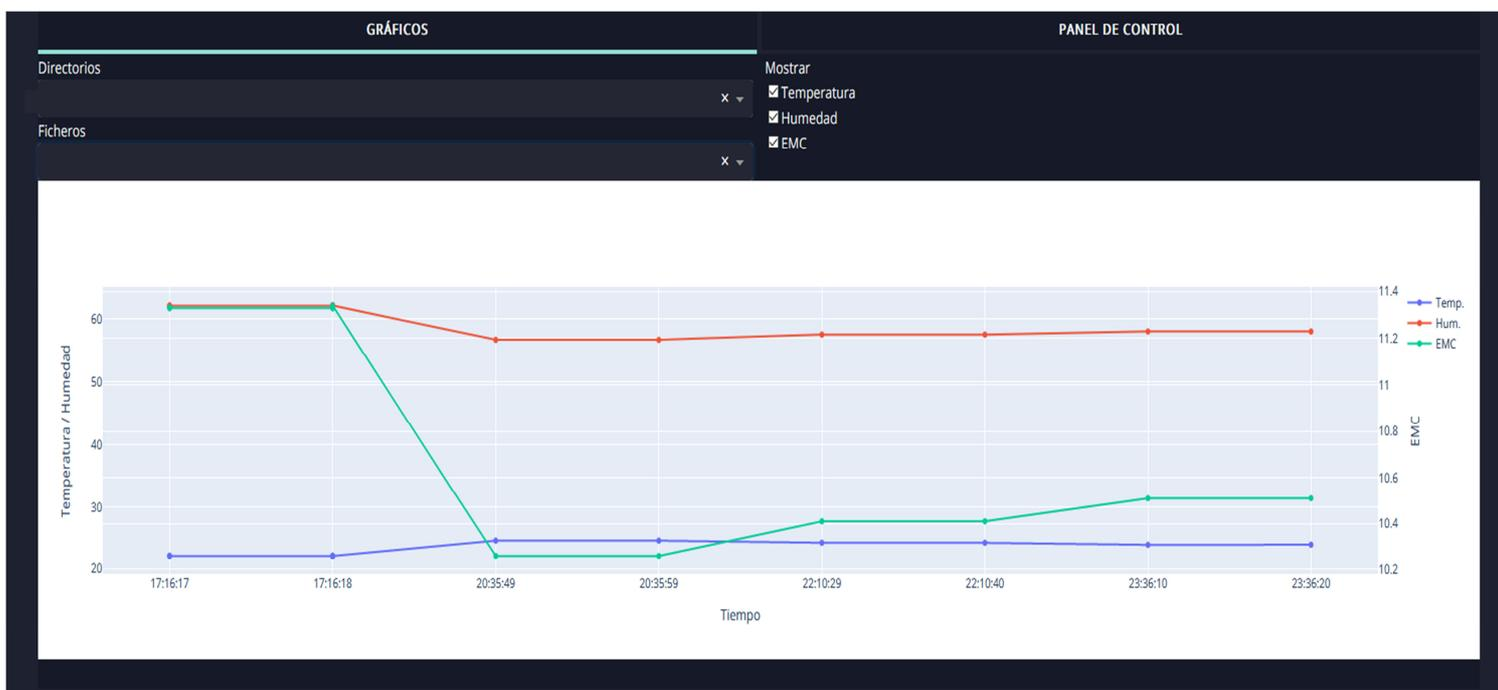
Imagen 2. Ejemplo de la interfaz provisional que se está desarrollando en el proyecto SISPATINT 2021 para la visualización de datos de la madera. En este ejemplo se muestran solamente tres variables (temperatura ambiental, humedad ambiental y contenido en humedad).
