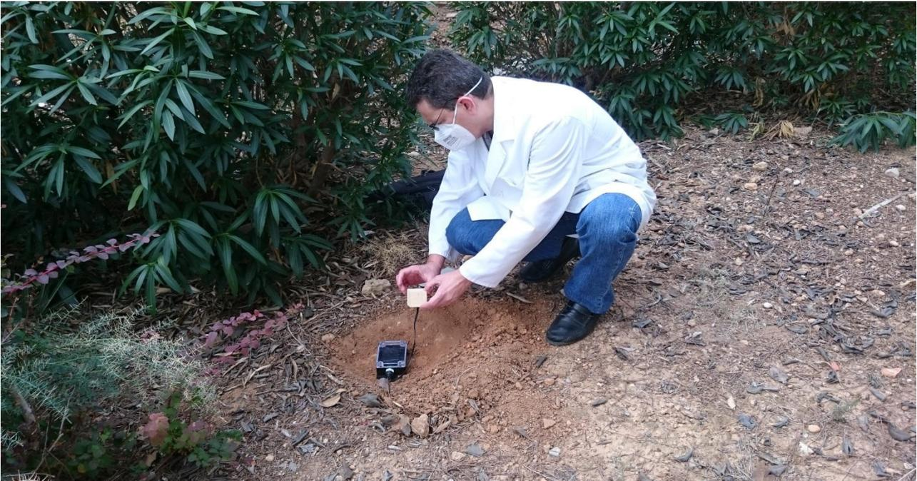
Imagen 45. Comprobación del funcionamiento del nodo sensor nº 7 antes de enterrarlo.
