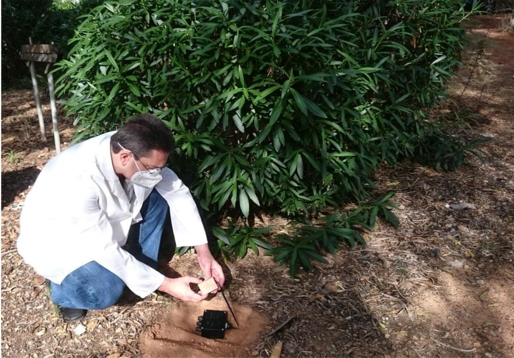
Imagen 49. Comprobación del funcionamiento del nodo sensor nº 3 antes de enterrarlo.
