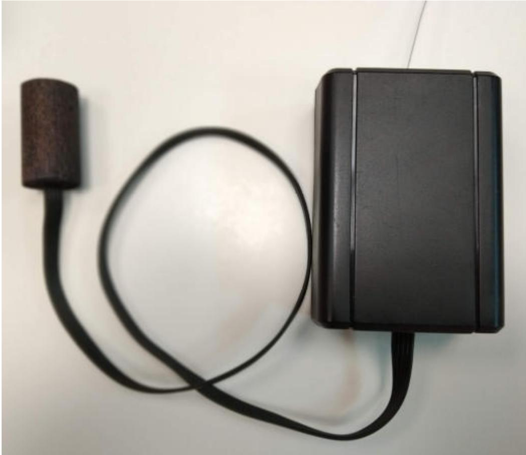
Imagen 15. Nodo sensor. DIPP\_SENS, DIPP\_RF y cable de unión.
