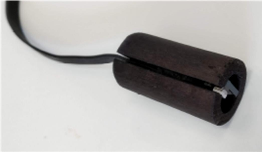
Imagen 13. Fotografía de DIPP\_SENS con el encapsulado de madera.
