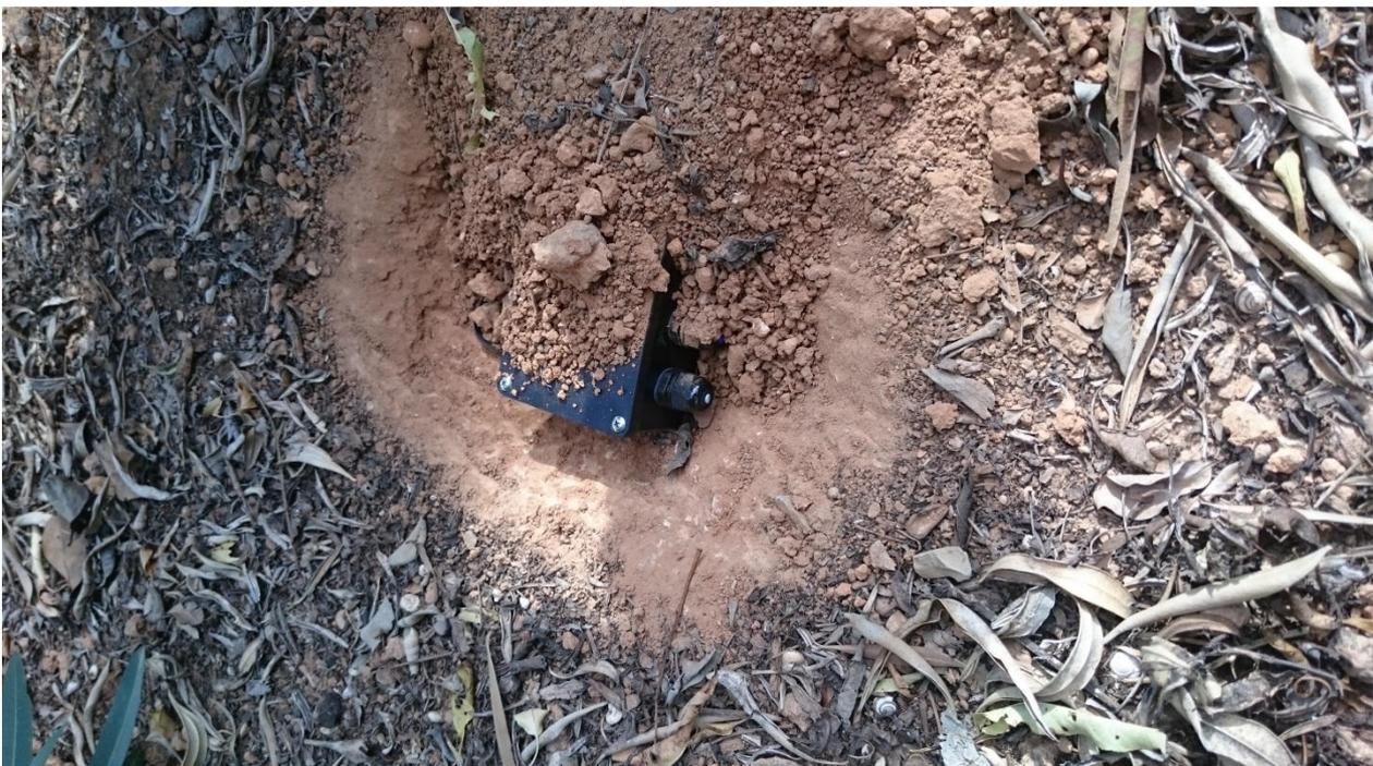
Imagen 50. Nodo sensor nº 3 en proceso de enterramiento.
