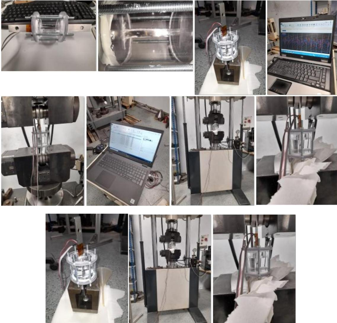
Figura 59. Probeta 2 dentro del recipiente de policarbonato con líquido. Fuente: Elaboración propia.
