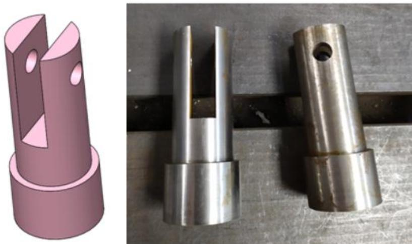
Figura 18. Modelo 3D e imagen real del adaptador para la mordaza. Fuente: Elaboración propia.
