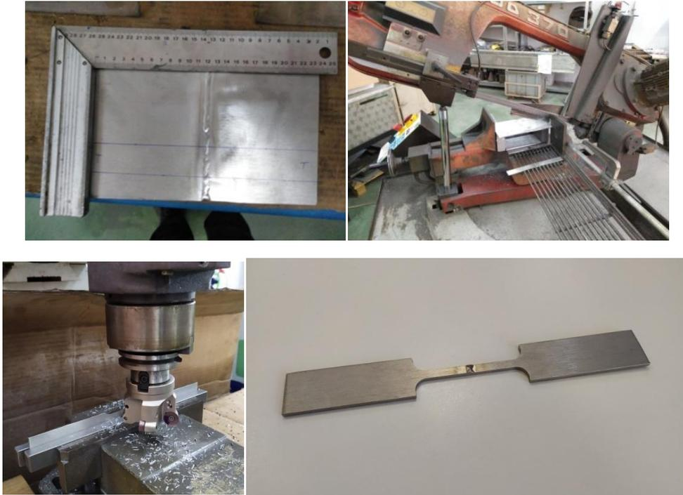
Figura 27. Operaciones de recorte y mecanizado de las probetas. Fuente: Elaboración propia.
