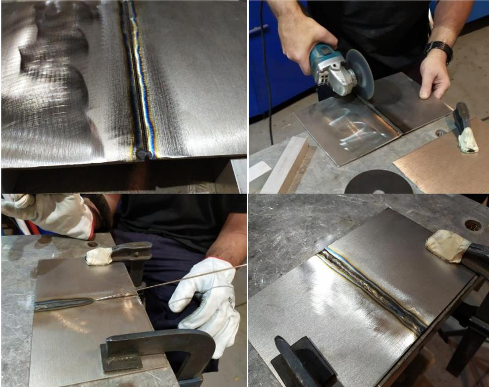
Figura 26. Preparación y ejecución de la segunda pasada de soldadura. Fuente: Elaboración propia.
