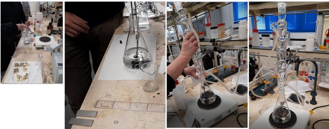
Figura 61. Probeta 3 cortada y sometida al baño hirviente de disolución de cloruro de magnesio.
