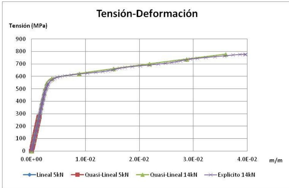
Figura 69. Resultados tensión-deformación a partir de la simulación. Fuente: Elaboración propia.
