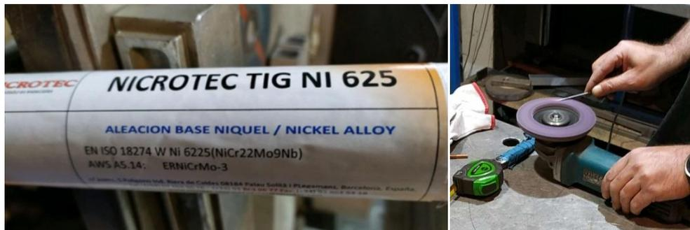
*Figura 23. Detalle material de aporte y afilado del electrodo. Fuente: Elaboración propia.*
