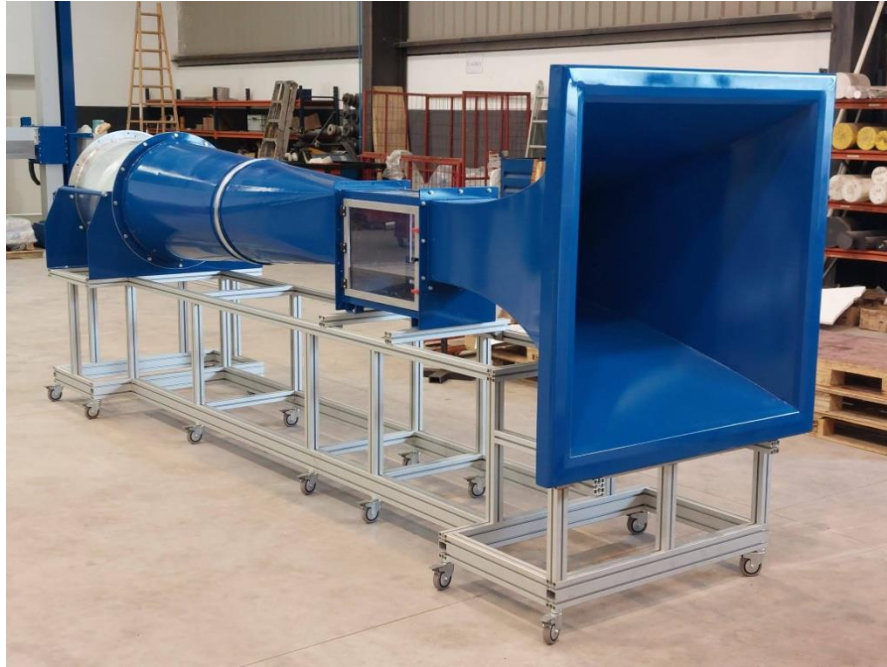
Ilustración 16. Banco de ensayos de viento.
