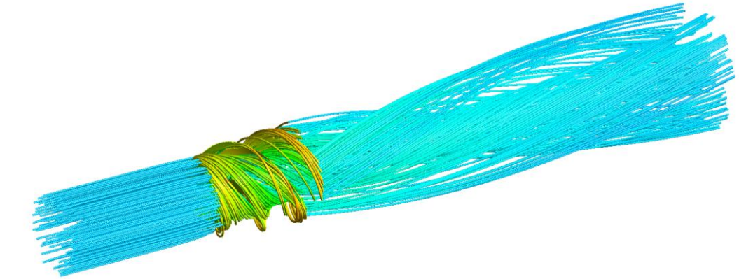
Ilustración 9. Líneas de corriente con distribución de velocidad del tornillo a 10 rpm.
