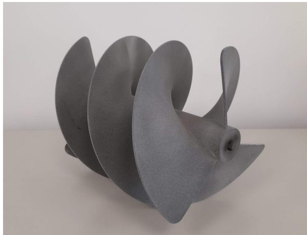
Ilustración 1. Prototipo de ensayo de tornillo de Arquímedes.
