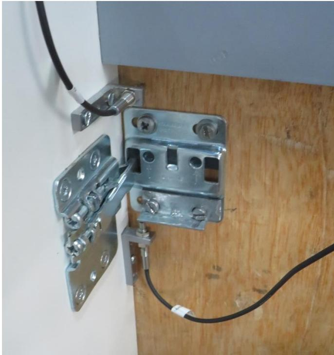
Ilustración 13: Disposición final de los sensores
