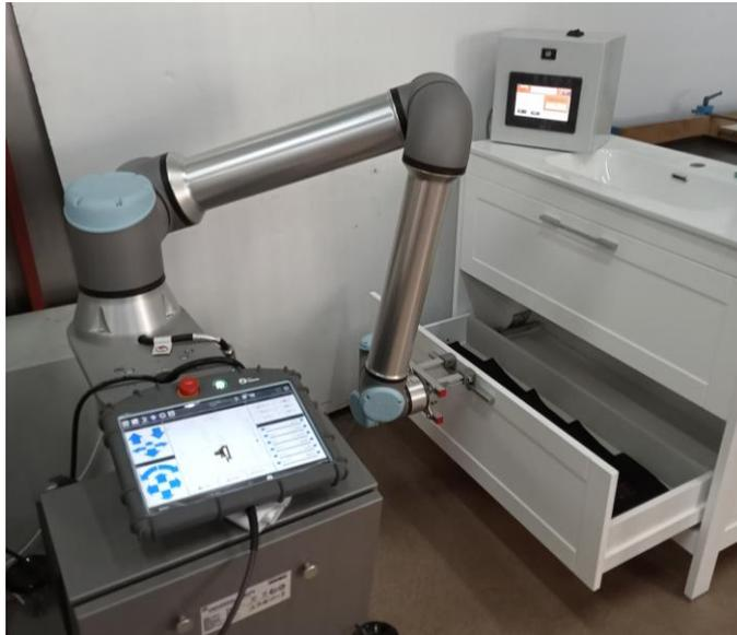
Ilustración 8: Robot realizando el ensayo de durabilidad en estado apertura
