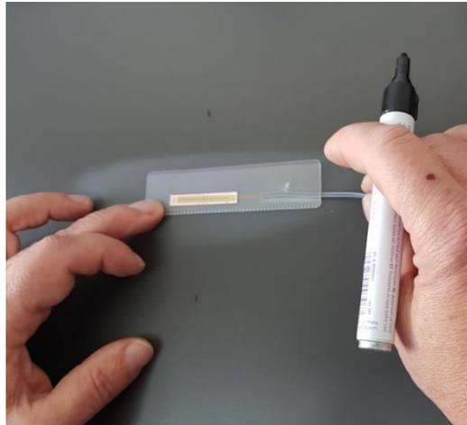
Ilustración 15: Proceso de incorporación de la galga extensiométrica
