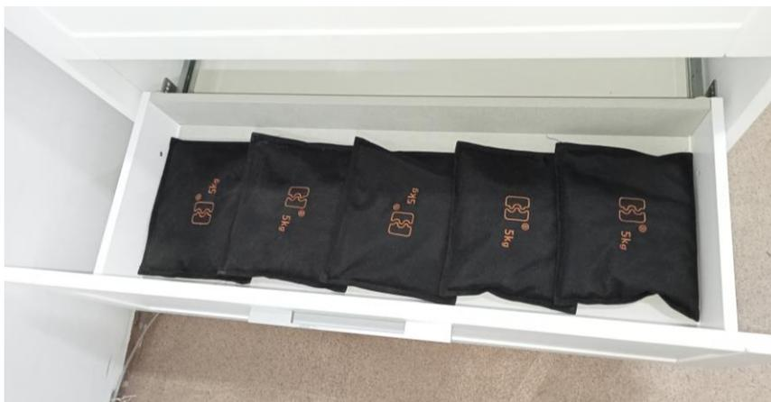
**Ilustración 6: Aplicación de la carga (25 kg) al elemento a ensayar**
