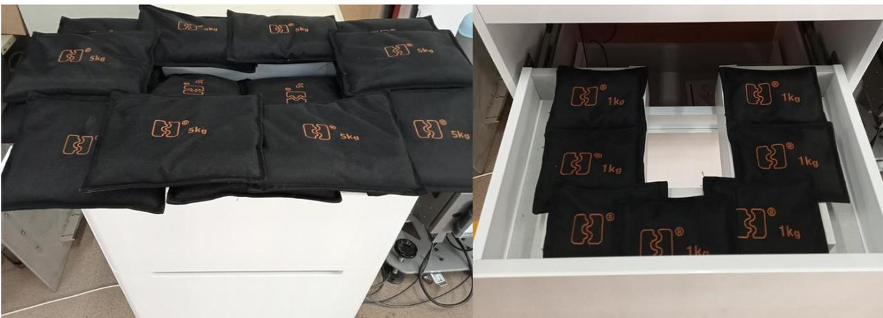
Ilustración 14: Aplicación de carga, ensayo de sobrecarga.
