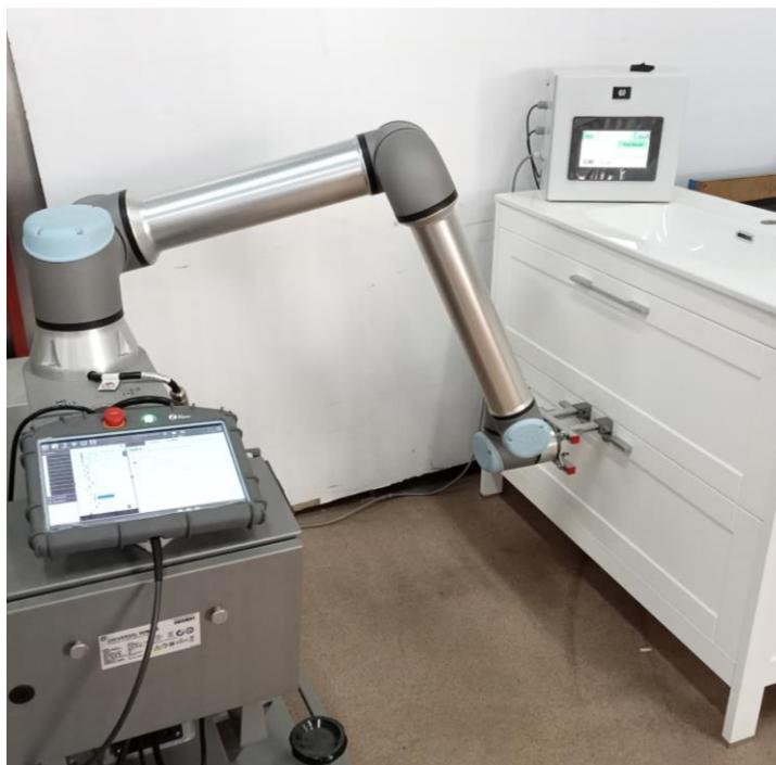
Ilustración 9: Robot realizando el ensayo de durabilidad en estado cierre
