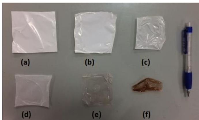
Figura 18. Aspecto de las membranas tipo CA143 lavadas tras estar 1 hora en la estufa a diferentes temperaturas (a) 60°C, (b) 70°C, (c) 80 °C, (d) 90 °C, (e) 125 °C y (f) 150 °C.
