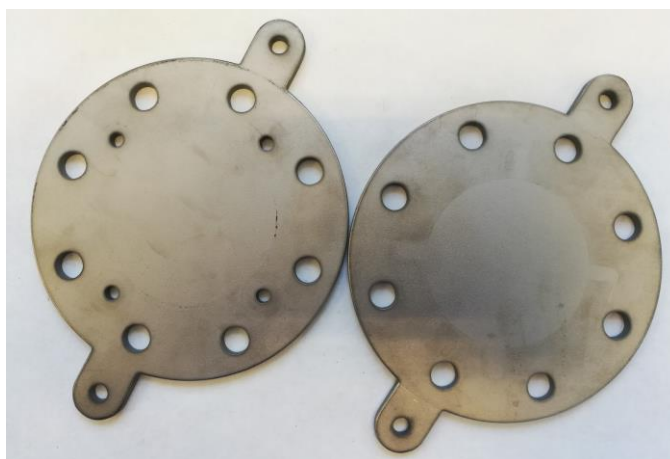
Figura 23 Colectora de corriente del ánodo (izquierda) y colectora de corriente del cátodo (derecha).
