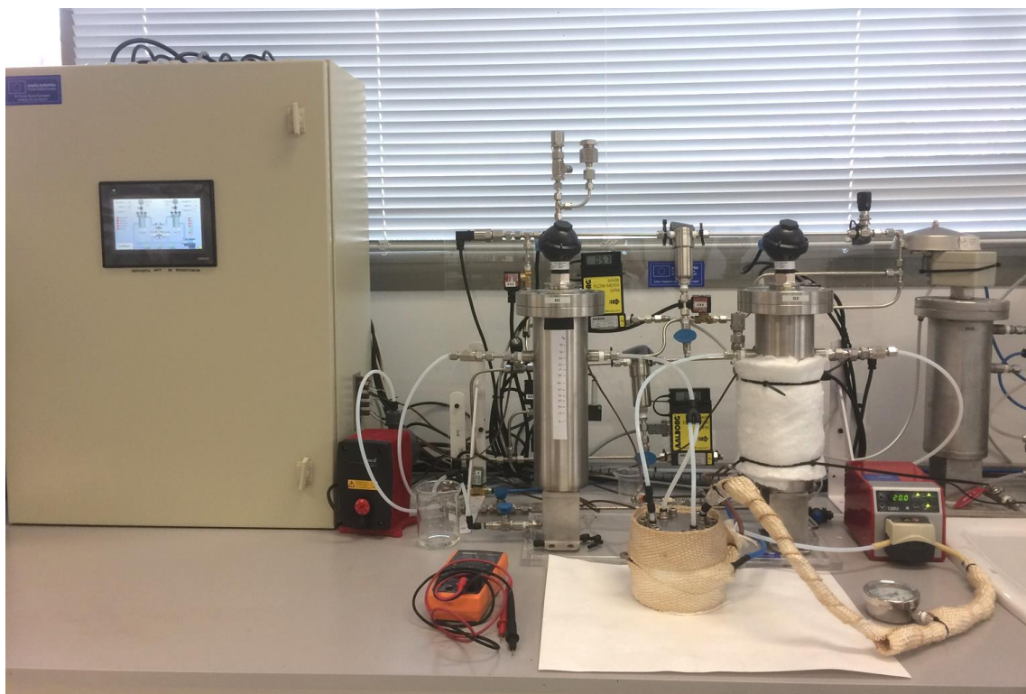
Figura 27. Banco de pruebas de electrolizadores PEM. Monocelda 2017.
