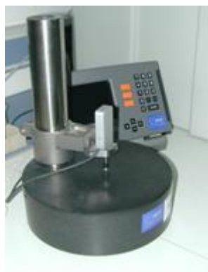
Figura 10. Equipo utilizado para medir los espesores de las membranas.
