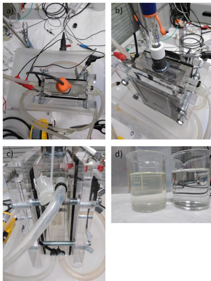
Figura 43. a), b) c) Montaje experimental de la celda filtro prensa para síntesis de nanopartículas de Pt sobre diferentes soportes. d) Disolución de síntesis antes de realizar la síntesis y después. Condiciones: 0.5 M \text{H}_2\text{SO}_4 + 0.5 mM \text{H}_2\text{PtCl}_6 .
