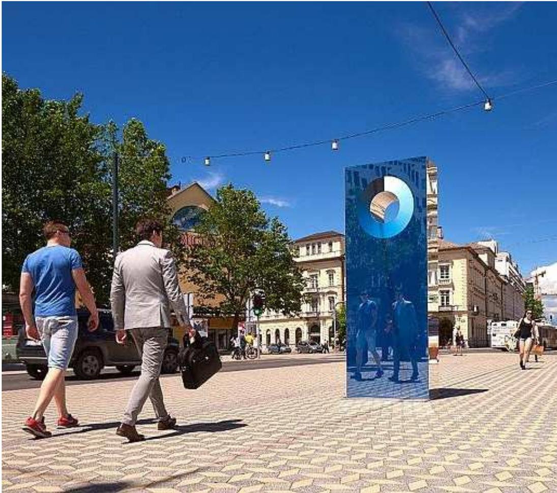
**Imagen 8. Ejemplo de objeto urbano inteligente clasificable en la subtendencia “Información al momento” de la tendencia “Conectividad”. Es un cianómetro digital que captura imágenes del cielo y las traduce en tonos de azul. Cuenta con paneles solares en el techo y ofrece información sobre la calidad del aire, la temperatura y las condiciones meteorológicas. Fuente: Iztok Medja.**
