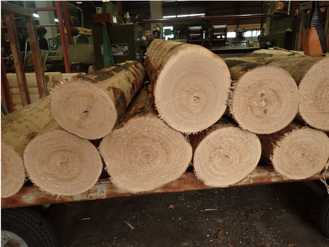
Imagen 8. Rollizos de paulownia descortezados y preparados para su desenrollo
