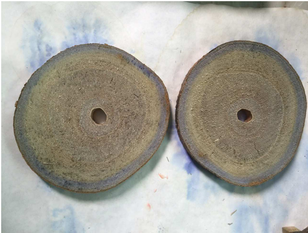
Imagen 5. Ensayo de determinación de albura en corte transversal del tronco de paulownia.
