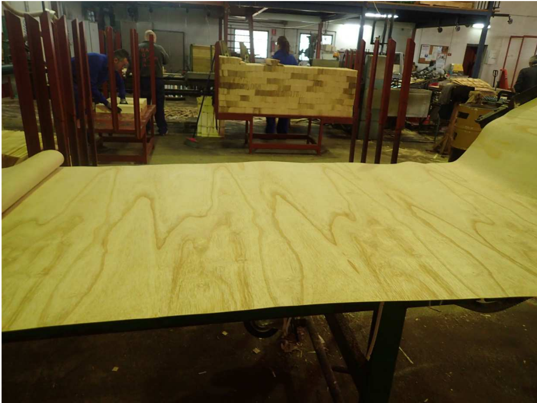
Imagen 9. Proceso de desenrollo. Detalle del dibujo y veta de la chapa
