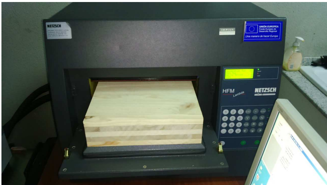
Imagen 18. Ensayo de conductividad térmica de tableros contralaminados
