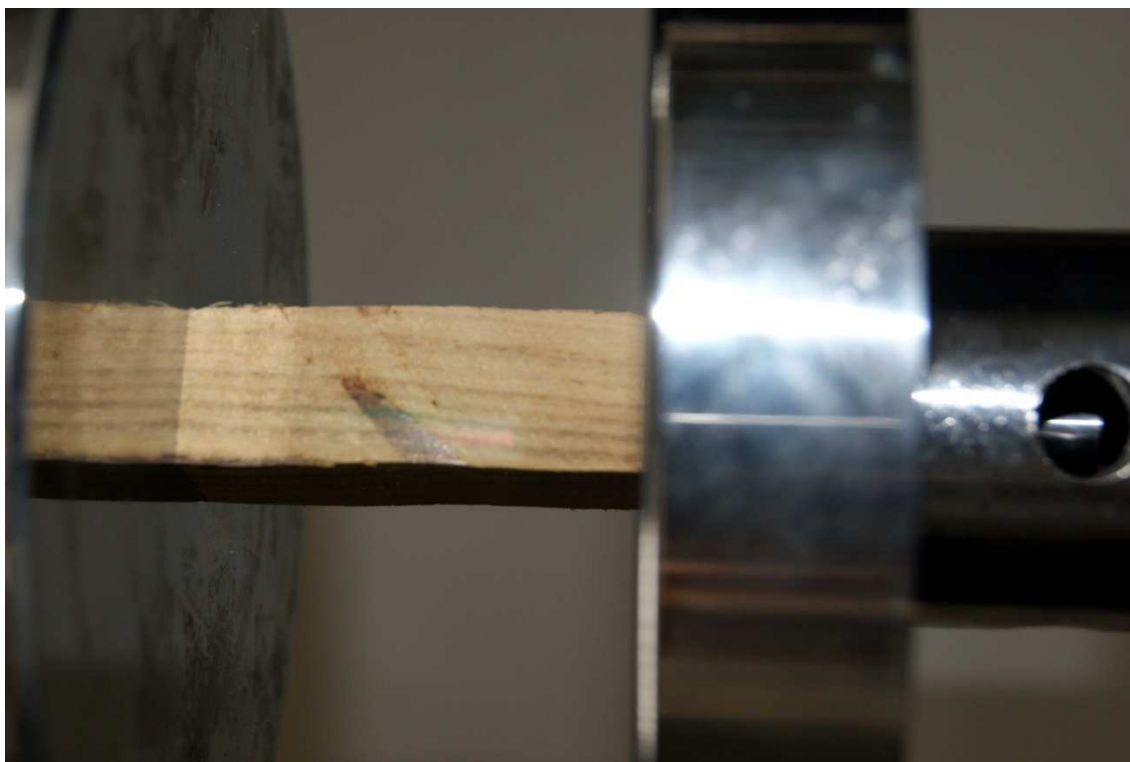
Imagen 4. Ensayo de compresión axial en robinia.
