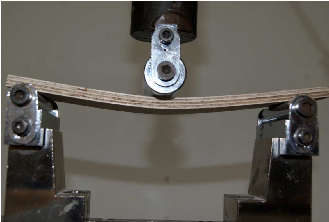
Imagen 16. Ensayo de resistencia a flexión del tablero fenólico
