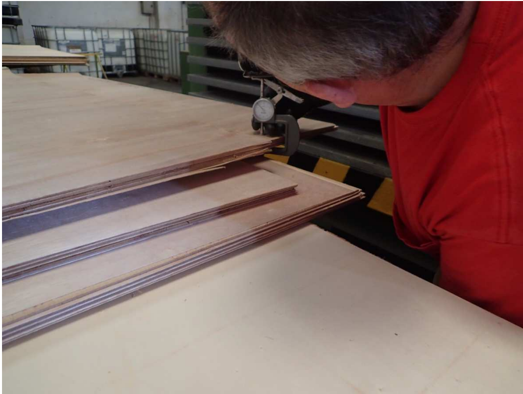
Imagen 10. Proceso de encolado de tableros. Comprobación del espesor del tablero antes del calibrado
