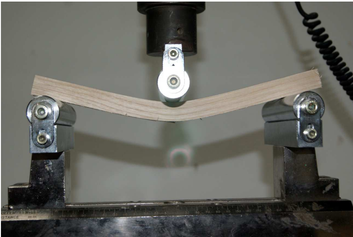
Imagen 3. Ensayo de flexión estática en almez
