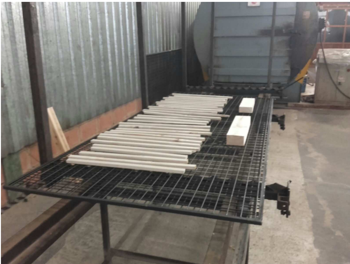
Imagen 7. Preparación de las muestras a la entrada del autoclave orgánico (Cipermetrina y Tebuconazol)
