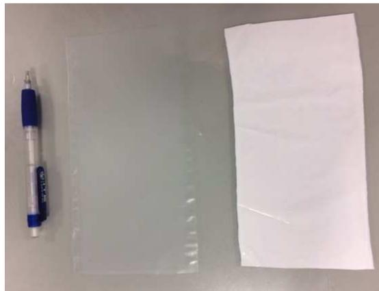
**Figura 6: Fotografías de la membrana tipo CA143 sin lavar (izquierda) y lavada (derecha)**
