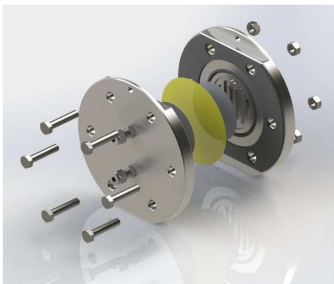
Figura 8: Ensamblado 3D monocelda redonda
