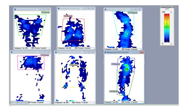
Figura 5. Ejemplo de mapas de presiones del H9 para la configuración de núcleo uniforme en color blanco. Datos mostrados: presión pico en las zonas delimitadas y presión media de la manta.
