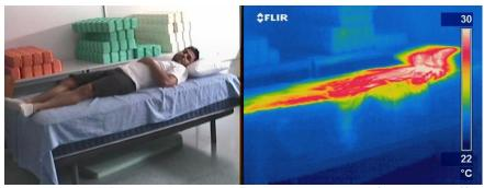
Figura 3. Imagen de la prueba de transpirabilidad del prototipo con cámara termográfica.
