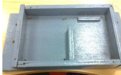
Figura 101. Carcasa para la ubicación de batería y placa controladora. Fuente: elaboración propia.
