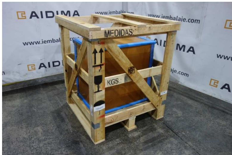
Figura 111. Resultado de ensayo de caída rotacional 2. Fuente: elaboración propia.
