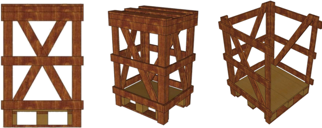
Figura 95. Bocetos de unidad de carga con laterales apoyando en exterior de la base. Fuente: elaboración propia.
