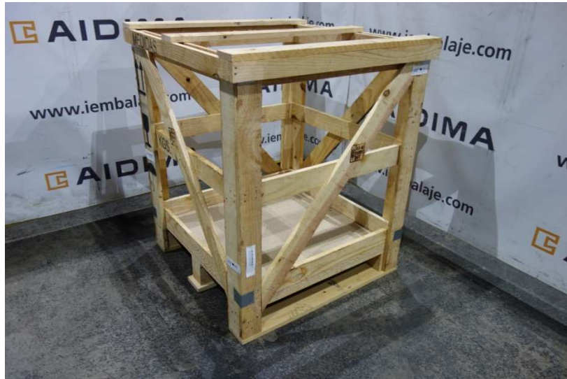
Figura 108. Resultado de ensayo de caída rotacional 1. Fuente: elaboración propia.
