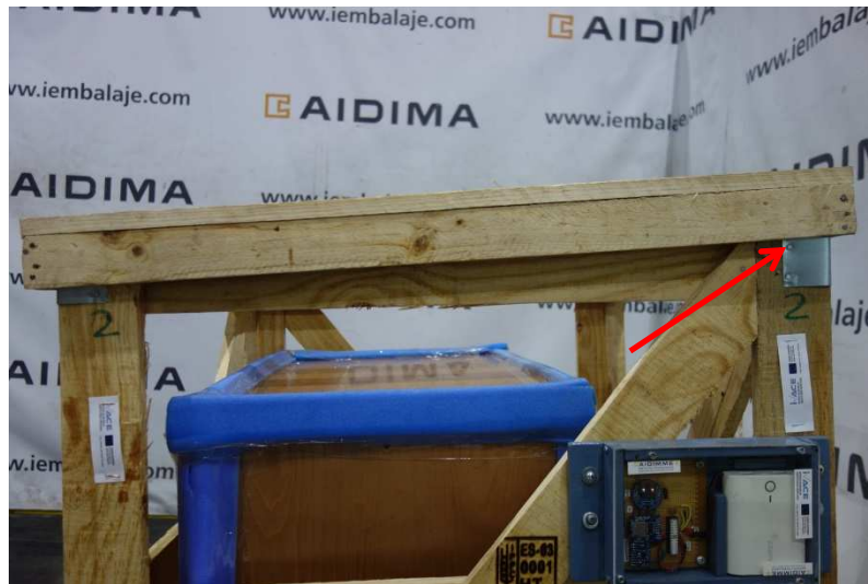
Figura 114. Imagen de la elevación de la tapa tras impactos. Fuente: elaboración propia.
