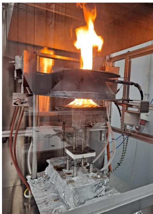
Figura 3. Probeta durante el ensayo de cono calorimétrico
