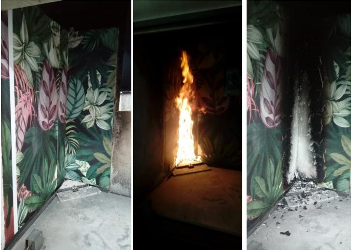
Figura 9. De izquierda a derecha: Muestra PFT-10 antes del ensayo SBI, durante el ensayo y después.
