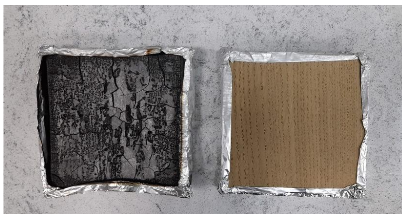
Figura 4. Aspecto muestra PFT-09 antes y después del cono calorimétrico
