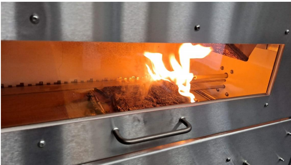
Figura 10. De Muestra durante el ensayo del panel radiante.
