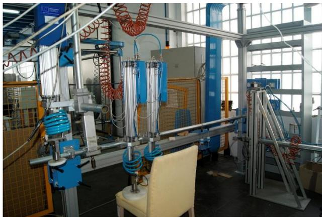
*Figura 7. Prueba de durabilidad del borde delantero del asiento.*
