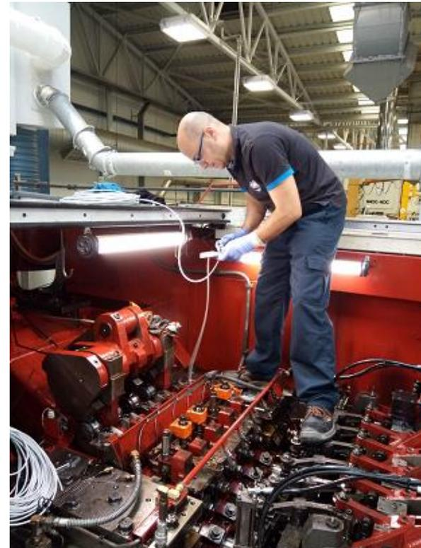
Técnico de AIDIMME instalando los sensores en la prensa de fabricación de tornillos
