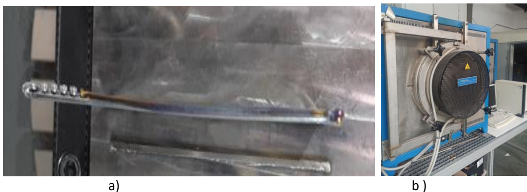
Figura 20 a) pieza tensionada de Ti64 b) horno de alto vacío Linn
