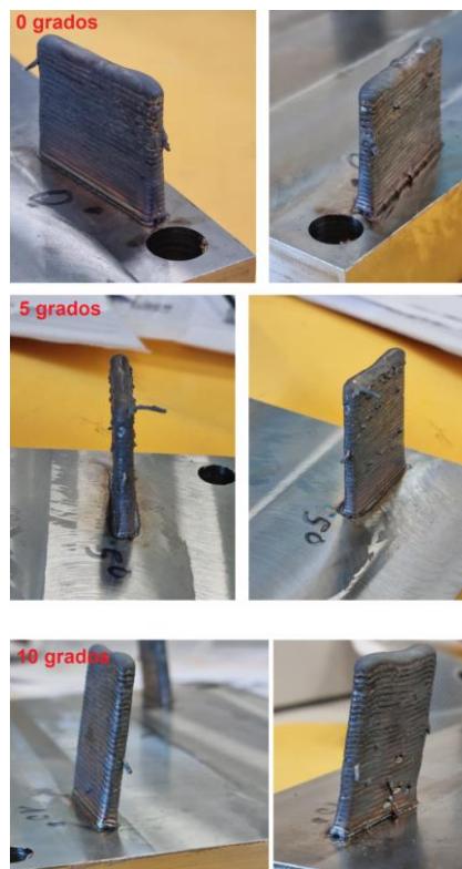
Figura 42 Test de voladizos en tecnología DED
