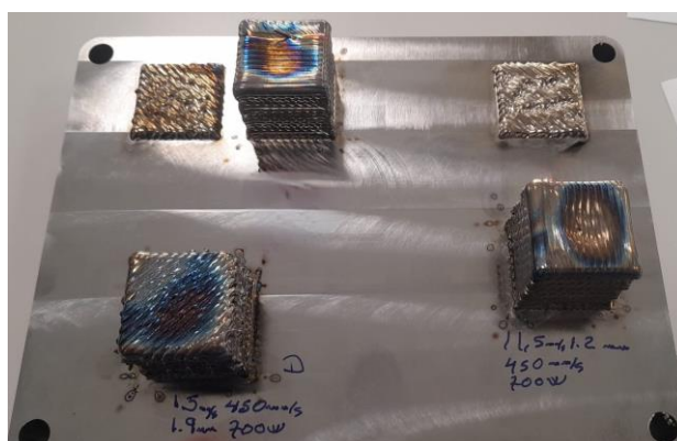
Figura 11 DOE de diferentes estrategias de superposición de capas
