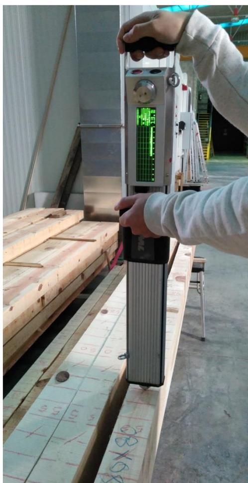
**Imagen 9. Realización de un ensayo de resistografía, técnica que forma parte de la metodología de evaluación no destructiva que se está acabando de desarrollar.**
