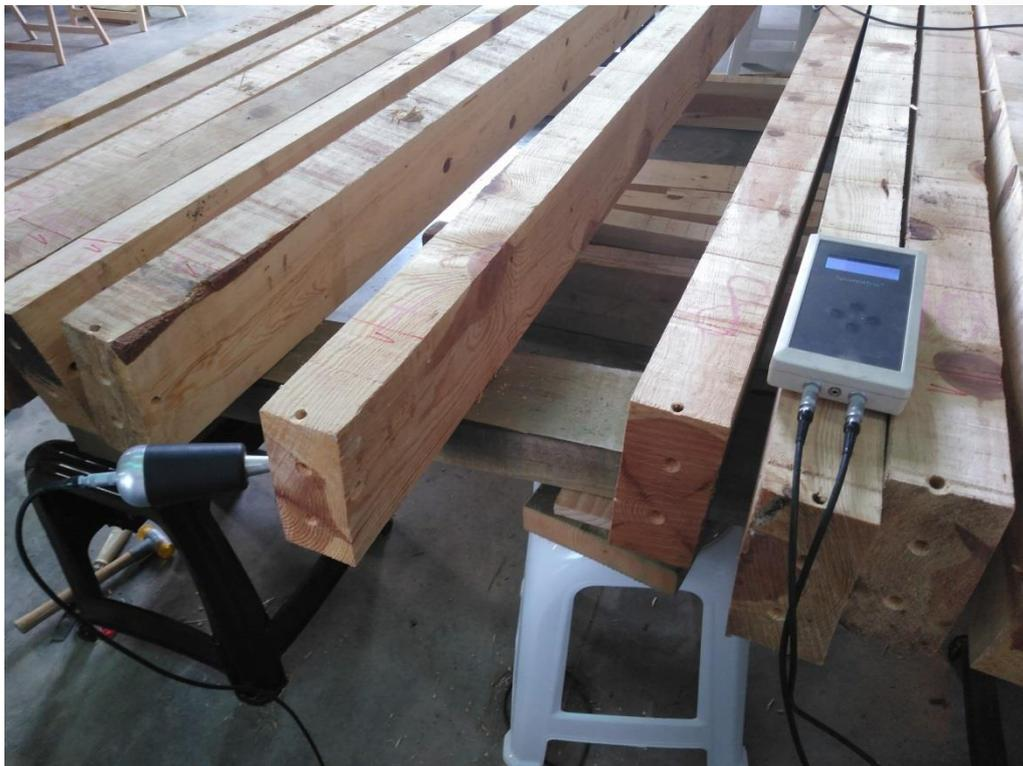
*Imagen 10. Realización de un ensayo de ultrasonidos, técnica que forma parte de la metodología de evaluación no destructiva que se está acabando de desarrollar.*
