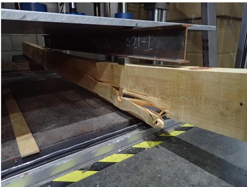
*Imagen 11. Rotura de una viga mediante ensayo de flexión según la norma UNE EN 408 para poder comparar los resultados con los obtenidos mediante la metodología en desarrollo de evaluación no destructiva.*
