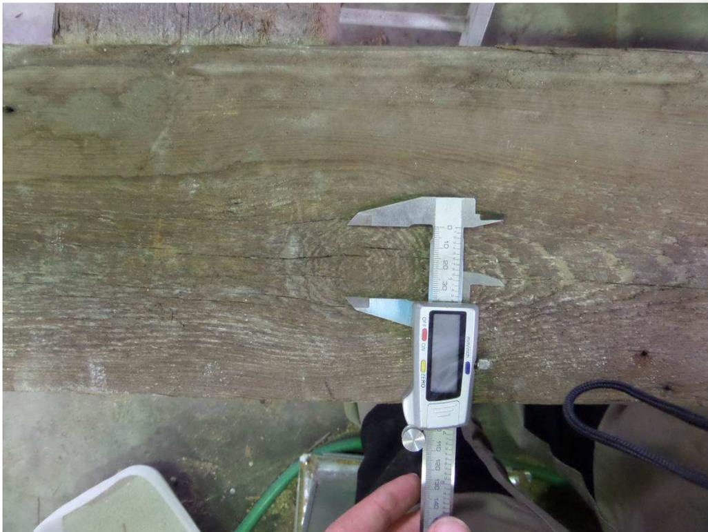
**Imagen 5. Medición de nudos en cara. La medición de los nudos grandes forma parte de la metodología mejorada.**
