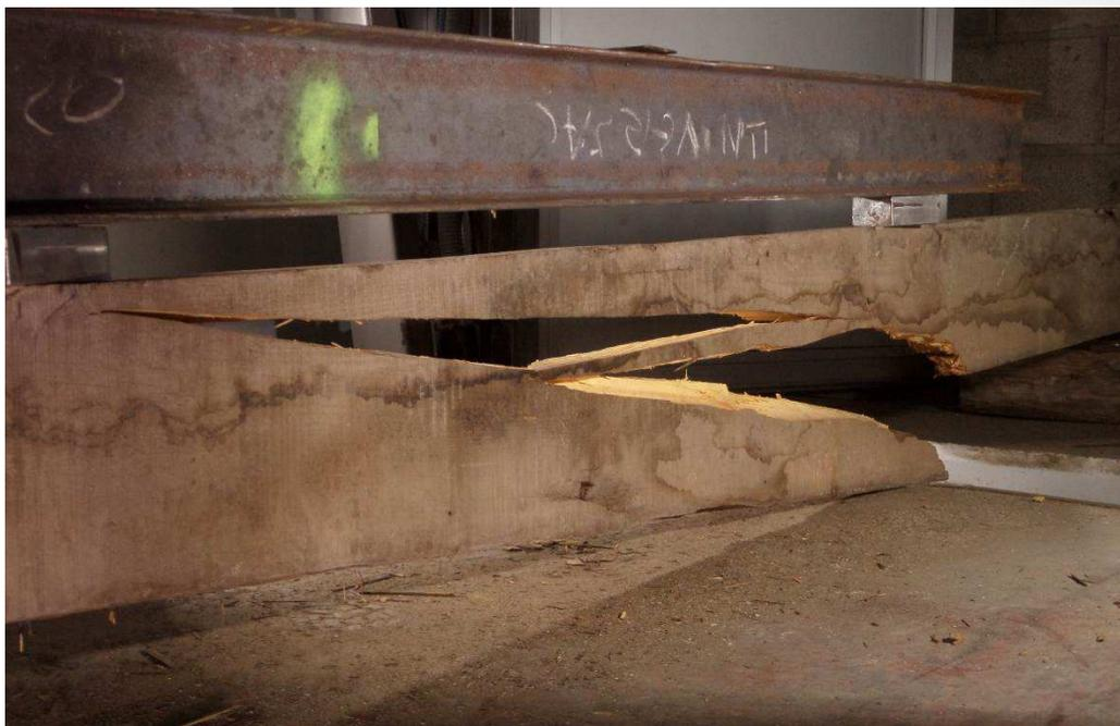
*Imagen 7. Ensayo de resistencia a flexión (destructivo).*
