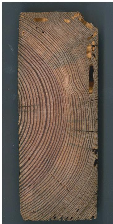
*Imagen 4. Sección de madera de mobla de clase de calidad B (MOB).*
