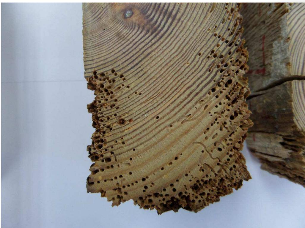
**Imagen 6. Detalle de una muestra con nivel de degradación 3 (el más severo).**
