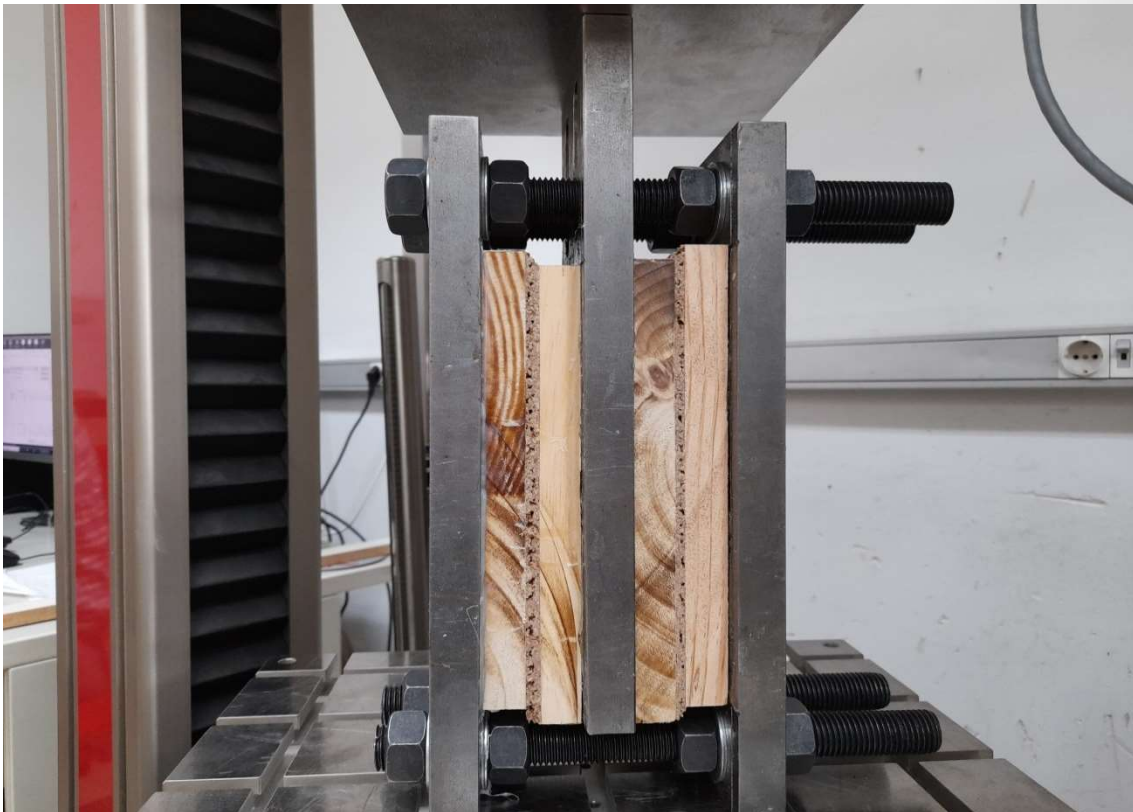
Imagen 7. Ensayo mecánico a cortante en un prototipo de los materiales innovadores desarrollados en INNOCOND.
