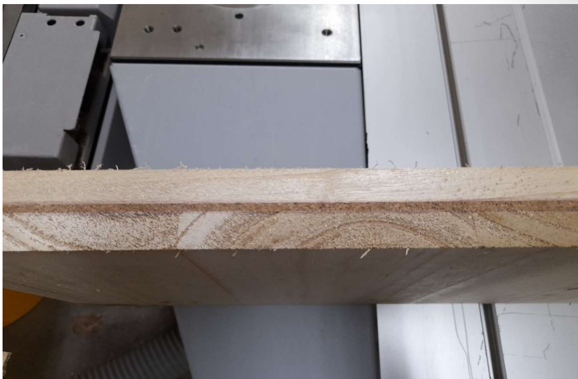
Imagen 3. Ejemplo de muestra de madera-nuevo material lignocelulósico-madera, después de aserrarla (formulación final del NML y madera de paulownia). El aserrado no disgrega el NML seco ni arranca trozos de él; es un corte muy limpio. La adhesión del NML, una vez seco, a la madera es correcta y su espesor es uniforme.
