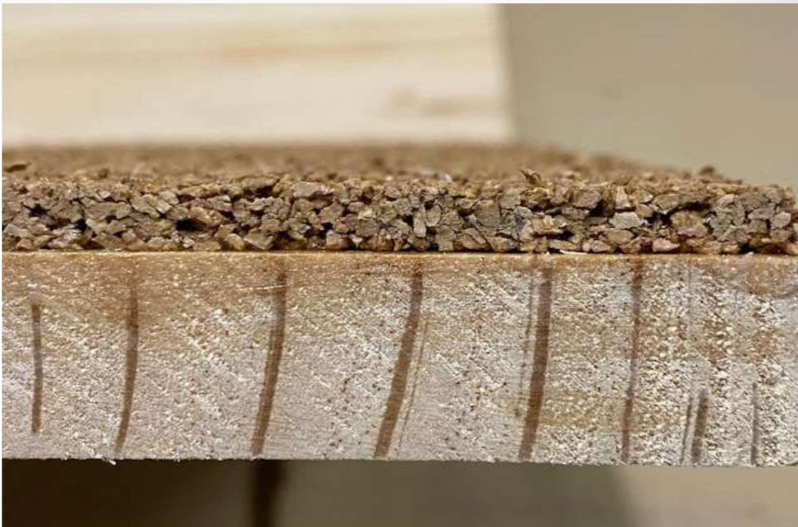
Imagen 1. Ejemplo del nuevo material lignocelulósico (NML) sobre una muestra pequeña de pino silvestre. El espesor del NML es de 5 mm; el del pino, 18 mm.
