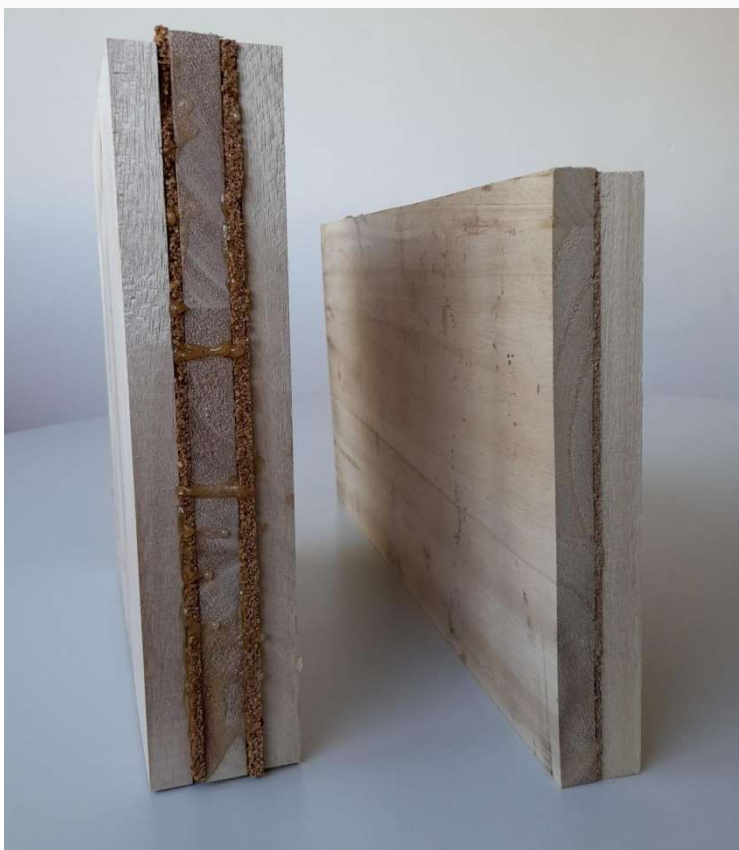
Imagen 5. Ejemplo de dos de los prototipos finales (contralaminado de 5 capas con paulownia y el nuevo material lignocelulósico)
