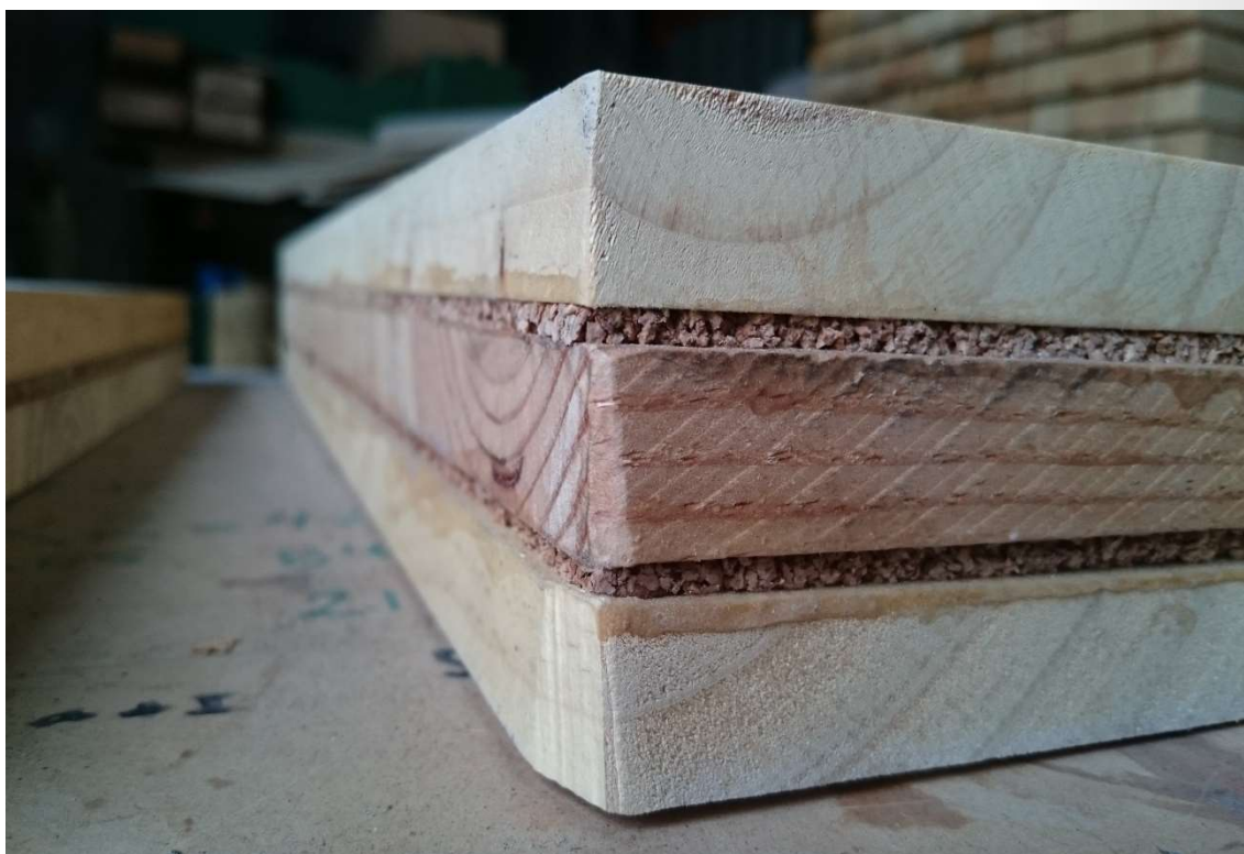
Imagen 4. Ejemplo de uno de los prototipos finales (contralaminado de 5 capas con pino y el nuevo material lignocelulósico).
