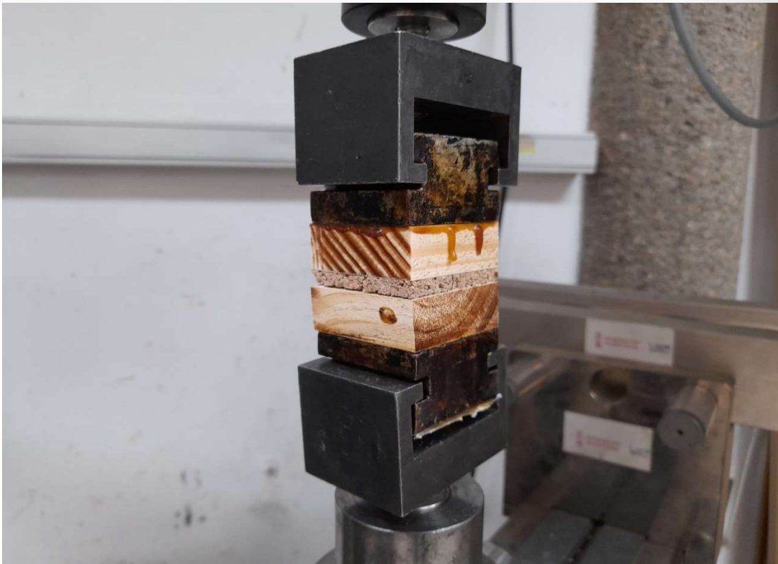
Imagen 6. Ensayo mecánico de tracción perpendicular a las caras en un prototipo de los materiales innovadores desarrollados en INNOCOND.
