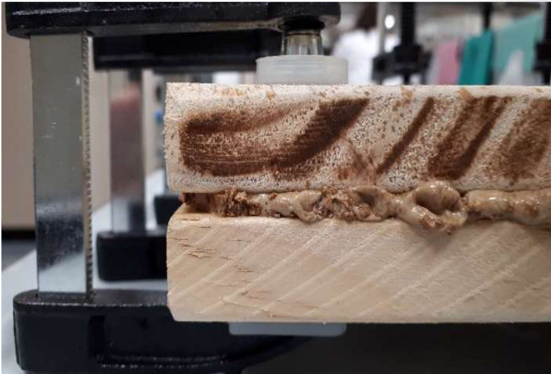
Imagen 2. Ejemplo del nuevo material lignocelulósico (NML) entre dos muestras pequeñas de pino silvestre. El espesor del NML es de 5 mm; el del pino, 18 mm. En esta prueba inicial, el secado fue en estufa a 50°C y la presión se ejerció mediante gatos.
