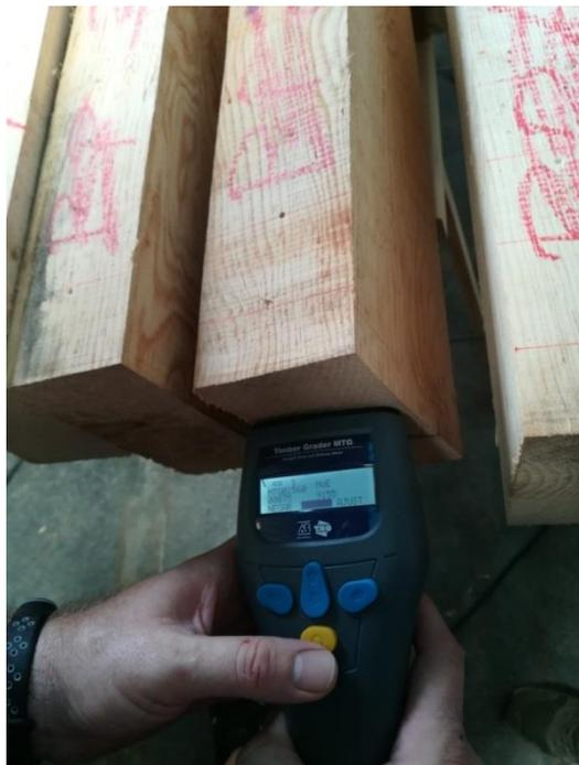
*Imagen 4. Técnica no destructiva de vibraciones inducidas/ondas de presión, que se usa en la metodología desarrollada.*
