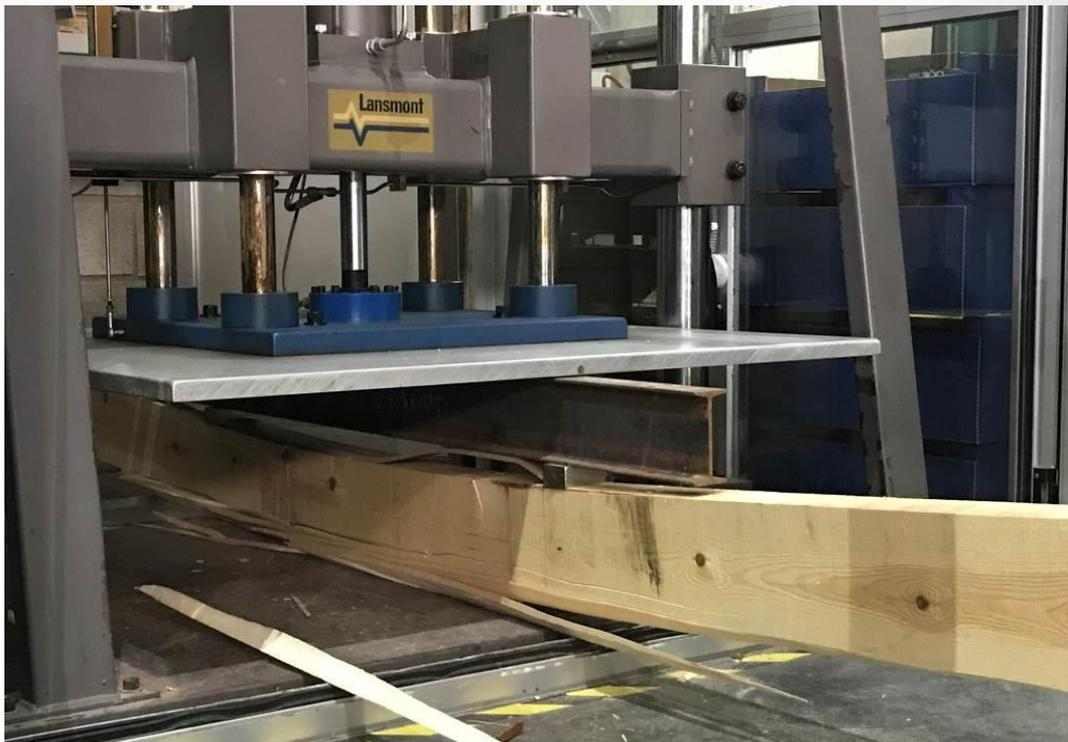
**Imagen 6. Rotura de una viga de pino silvestre en el ensayo de flexión según la norma UNE EN 408. Los resultados de la metodología no destructiva se comparan estadísticamente con los resultados a rotura para validarla y mejorarla.**
