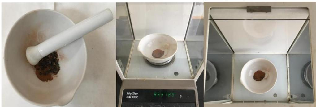
Ilustración 25 Molturado del nanocompuesto  $\text{Fe}_3\text{O}_4@\text{TiO}_2$  y pesado.
