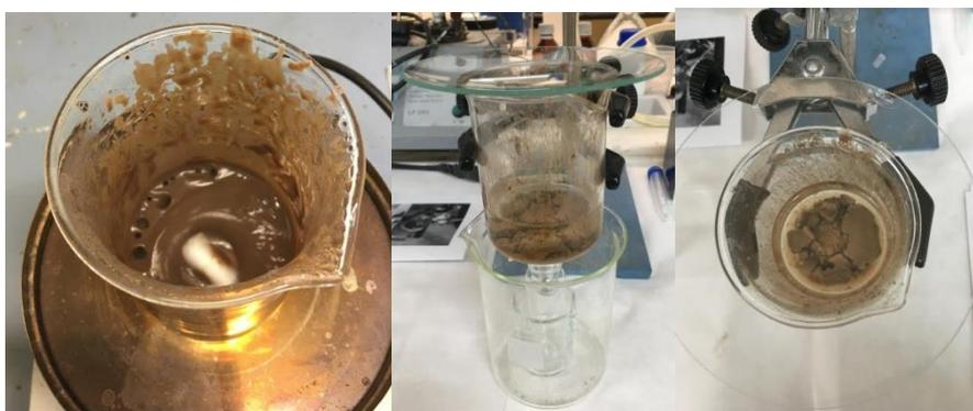
Ilustración 24 Formación del nanocompuesto  $\text{Fe}_3\text{O}_4@\text{TiO}_2$  de color marrón y decantación magnética con lavados de agua destilada (4 o 5 ciclos de 40 mL).
