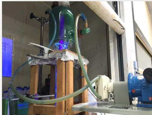
Ilustración 14 Reacción por fotocatalisis en reactor encamisado.
