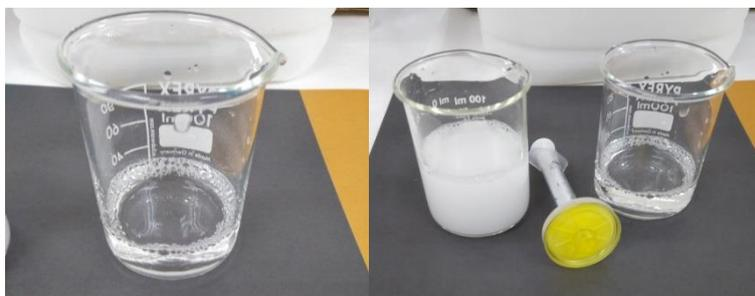
**Ilustración 30. Agua industrial concentrada antes y después de la filtración con tamaño de poro 0,45  $\mu m$**
