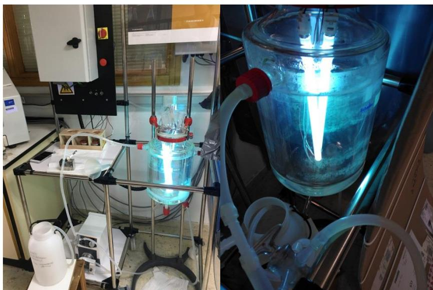
Ilustración 34. Agua Residual Industrial con elevado contenido en formaldehído, fotólisis en la UD con lámpara UV 370 nm, reactor 5 L y bomba peristáltica a 600 rpm. Sentido del flujo de las agujas del reloj.
