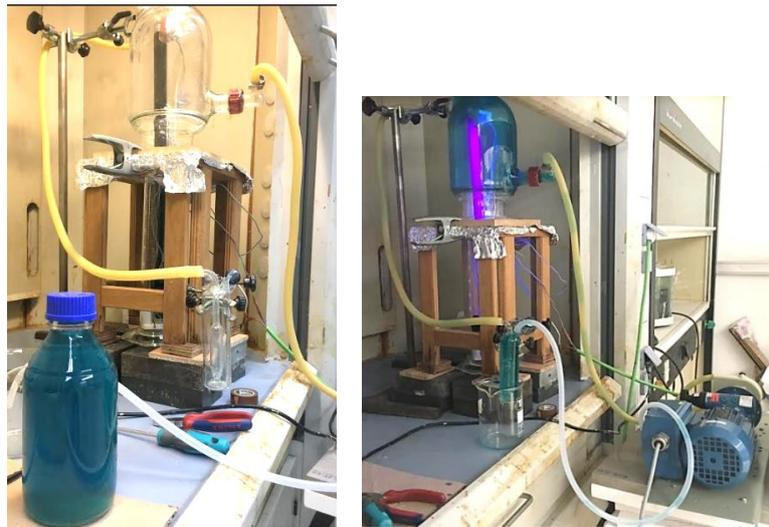
Ilustración 21 Llenado del contaminante azul de metileno y catalizador  $\text{Fe}_3\text{O}_4@\text{TiO}_2$  y posterior reacción fotocatalítica del sistema reactor encamisado de 1 L de volumen, con lámpara UV para irradiar ( $\lambda = 370 \text{ nm}$ ), trampa de condensados y bomba peristáltica de recirculación con potencia de agitación 3,0.
