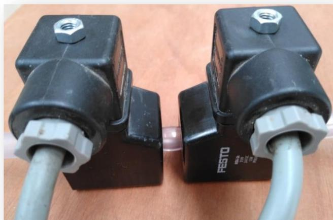
Ilustración 17 Sistema Electroimanes: de 24V DC, con conexiones eléctricas sumergibles para su refrigeración en baño de agua.
