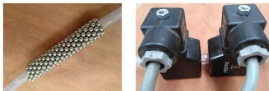
Evaluación de la recuperación de los nanocompuestos mediante imanes permanentes y electroimanes.
