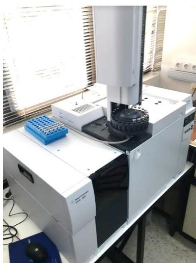
Ilustración 31. Cromatógrafo de gases modelo 7820A GC/5977B MSD.
