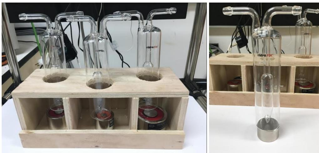
Sistemas de decantación magnética, electroimanes e imanes permanentes combinados en serie o en paralelo. Sentido del fluido vertical y frontal al campo magnético.
