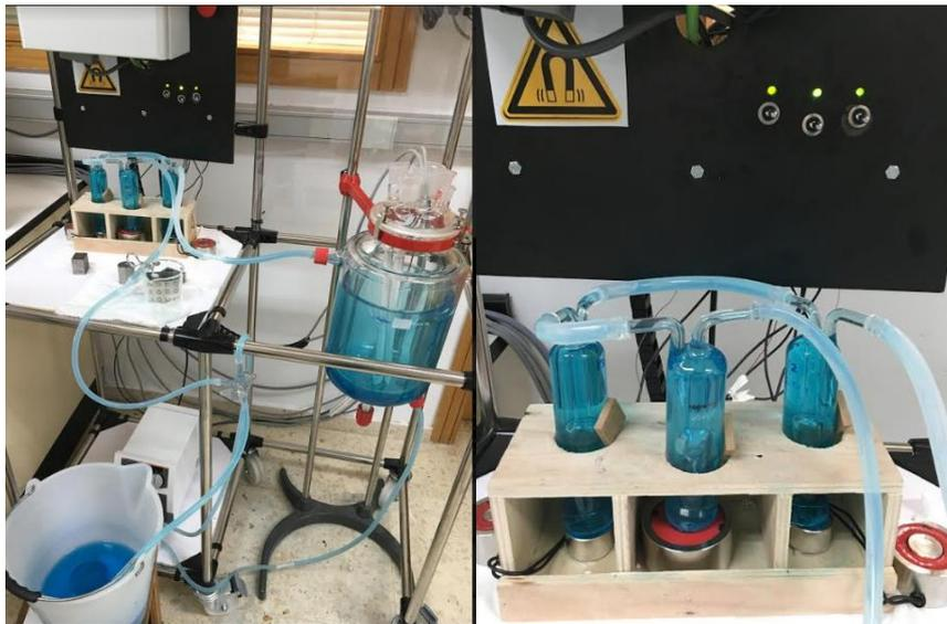
Ilustración 42. Activación del sistema de decantación magnética con dos imanes permanentes y el electroimán grande.
