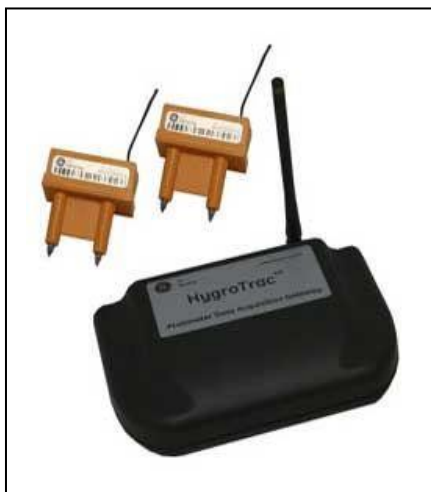
Imagen 15. Sensores inalámbricos HygroTrac. Fuente: http://www.gehygrotrac.com/
