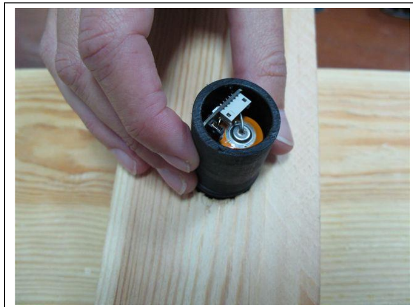
Imagen 31. Inserción del sensor final en la madera. El sensor está dentro de una carcasa abierta de madera pintada de negro para permitir la reflexión de luz y la entrada de termitas. Fuente: AIDIMME
