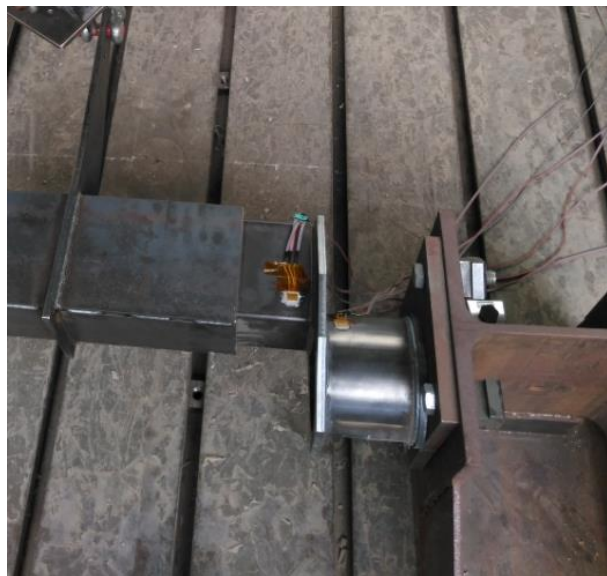
Figura 9. Rosetas de captura de deformación sobre estructura soldada.
