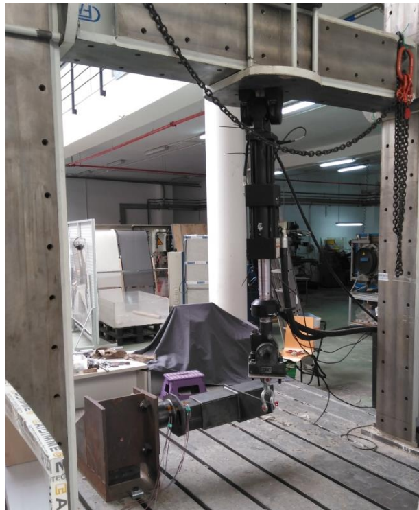
Figura 8. Ensayo de la estructura soldada.
