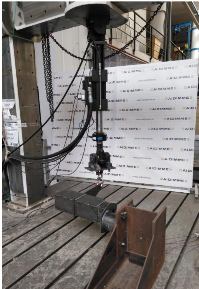
Figura 10. Ensayo sobre estructura soldada de estudio.
