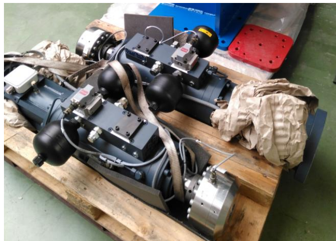
Figura 3. Actuadores hidráulicos de 250kN con células de carga.
