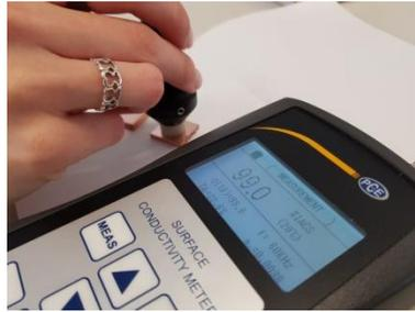
Ilustración 14. Medida de la conductividad eléctrica del material para comprobar su densificación
