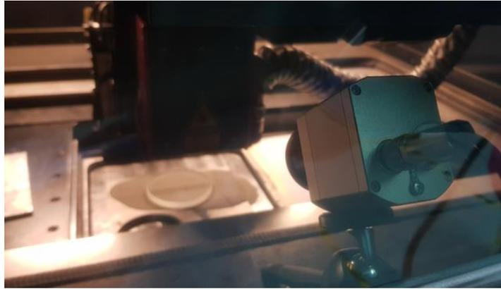
Ilustración 12. Adquirir feedback del proceso EBM y SLM, para desarrollo de sistema de detección de defectos.
