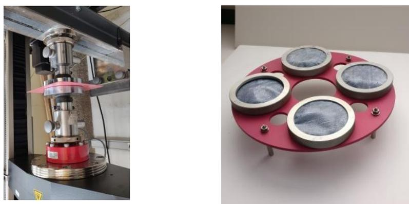
Figura 13. Ejemplos diferentes ensayos realizados sobre muestras analizadas en proyecto (Izquierda: Resistencia a la compresión. Derecha: Protección contra la humedad).
