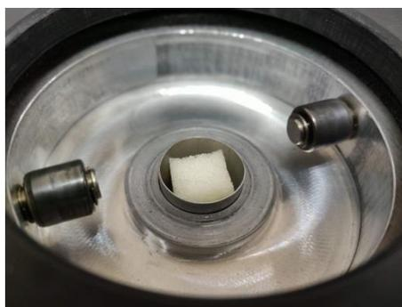
Figura 11. Determinación porosidad con picnómetro de gases
