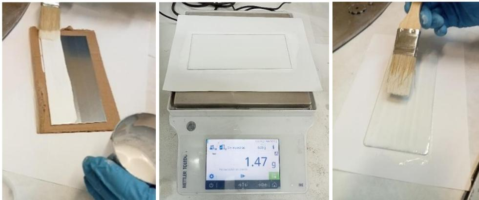
**Figura 30.** Aplicación de recubrimientos formulados sobre las probetas de acero.
