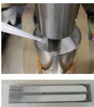
**Figura 27.** Grindómetro. Prueba de dispersión de pigmentos.
