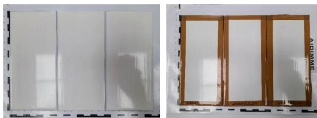
**Figura 47.** Probetas con recubrimiento aditivado con cáscara de plátano antes del ensayo.
