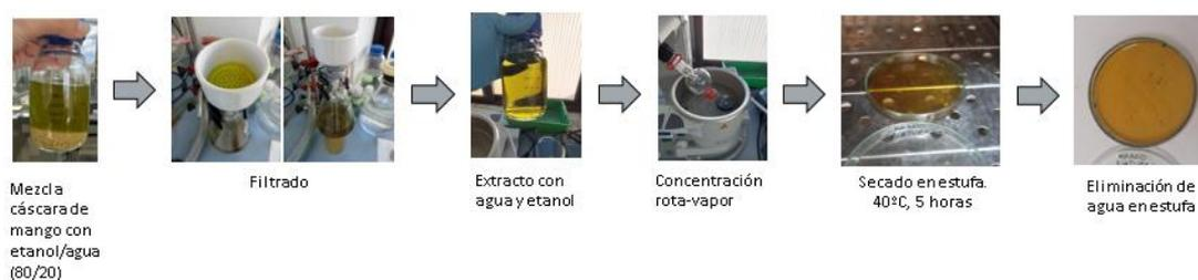
**Figura 20.** Esquema proceso de extracción por maceración de la cáscara de mango con etanol/agua (80/20) y ultrasonidos.
