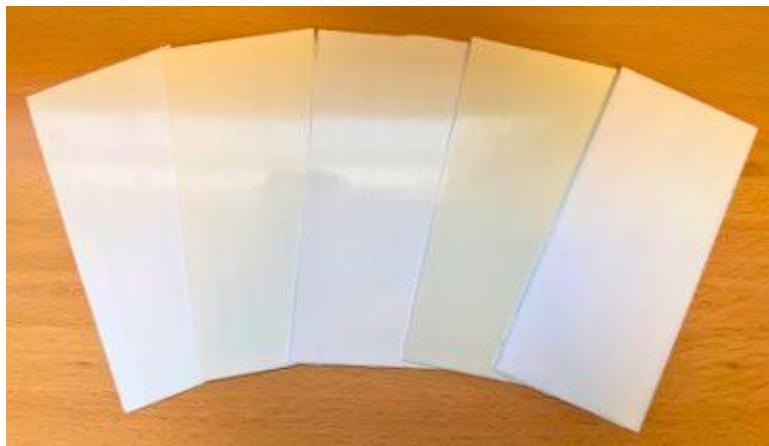
**Figura 31.** Recubrimientos desarrollados en el proyecto (de izq. a dcha.: recubrimiento sin aditivo, cáscara naranja, cáscara de plátano, cáscara de mango e inhibidor comercial.)
