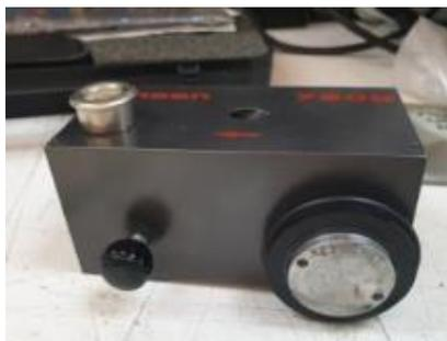
**Figura 7:** Instrumento de ensayo rayado lápiz.
