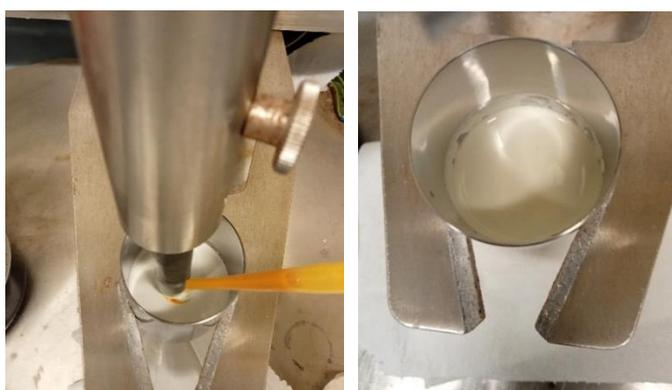
**Figura 29.** Formulación recubrimiento con cáscara de naranja en equipo Dispermat.
