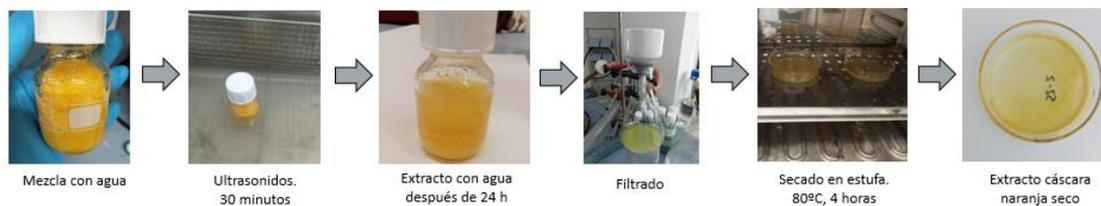
Figura 17. Esquema proceso de maceración con agua 100% y ultrasonidos.
