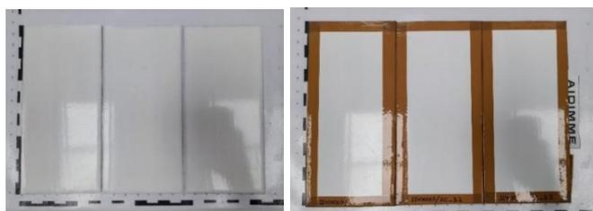
**Figura 45.** Probetas con recubrimiento aditivado comercial antes del ensayo
