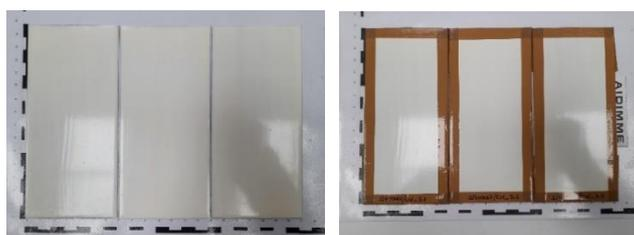
**Figura 46.** Probetas con recubrimiento aditivado con cáscara de naranja antes del ensayo.
