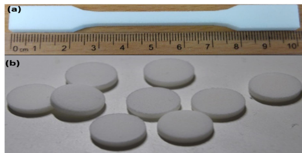
Figura 8. Imágenes de a) test de tracción y b) discos para cultivo celular preparados con PA12-nHa con diferentes proporciones de nHA. 6
