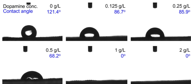
Figura 32. Ángulo de contacto del tejido sin PDA y tratado con diferentes concentraciones de PDA. 15
