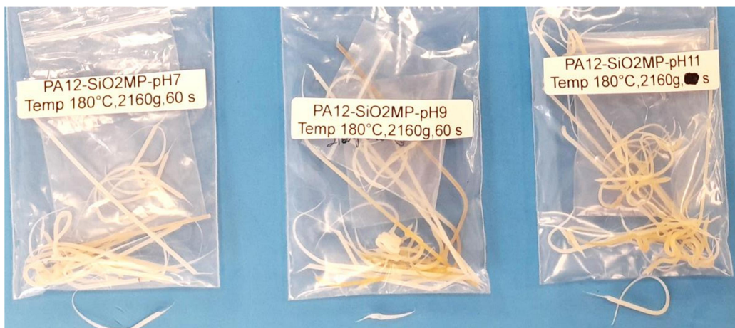
Figura 44. PA12-SiO 2 MP a diferentes pHs tras el ensayo del índice de fluidez.
