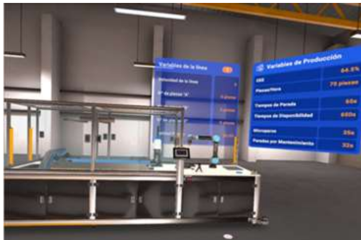
Visualización de la línea desde el gemelo digital con paneles de variables de la línea y variables de producción.
