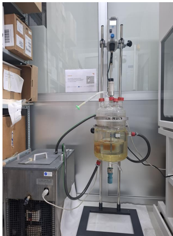
Figura 13. Sistema de biodegradación Proceso 2. Biodegradación de espumas de poliuretano flexibles a partir de un consorcio de bacterias AIDIMME en condiciones estancas.
