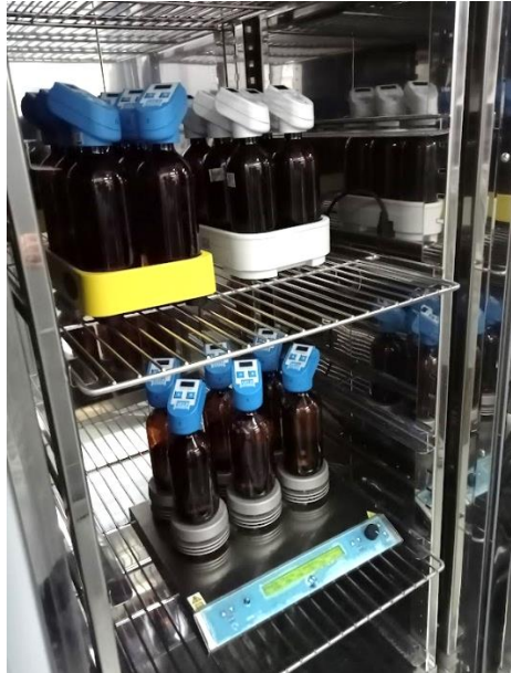
Figura 9. Matraces de ensayo en funcionamiento a temperatura de ensayo constante.
