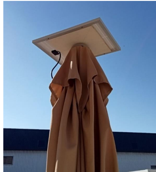
Ilustración 40: Incorporación panel solar
