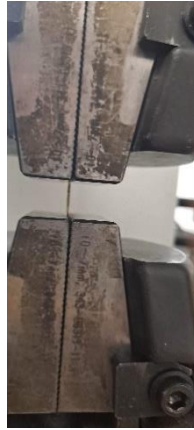
Figura 4 Ensayo realizado con una viruta analizada
