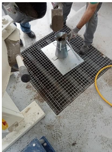
Figura 6 Fabricación de hormigón, ensayo de consistencia.
