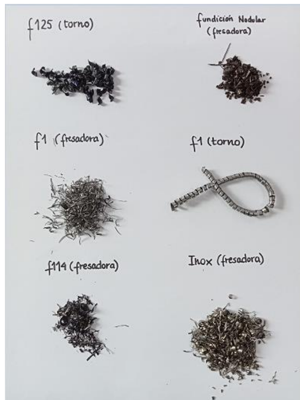
Figura 1. Virutas de diferentes procesos de mecanizado
