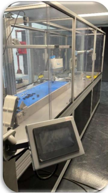
El demostrador de fabricación inteligente consta de una línea que simula el proceso de fabricación completo de memorias USB, totalmente automatizada. El USB está compuesto por tres partes, el cuerpo y la tapa que se han diseñado para este demostrador en particular han sido fabricadas mediante fabricación aditiva, la tercera parte es la electrónica encapsulada.
