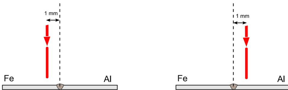
Figura nº 7. Sistemas empleados en las primeras pruebas para lograr la unión de chapas.
