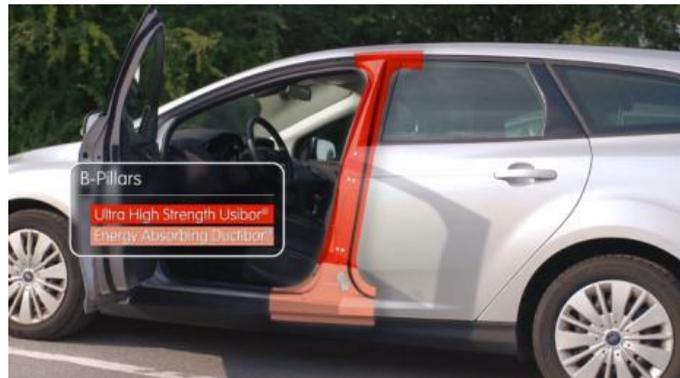
Figura nº 2. Componente del automóvil fabricado mediante el método “Láser welded blanks”.<sup>5</sup>
