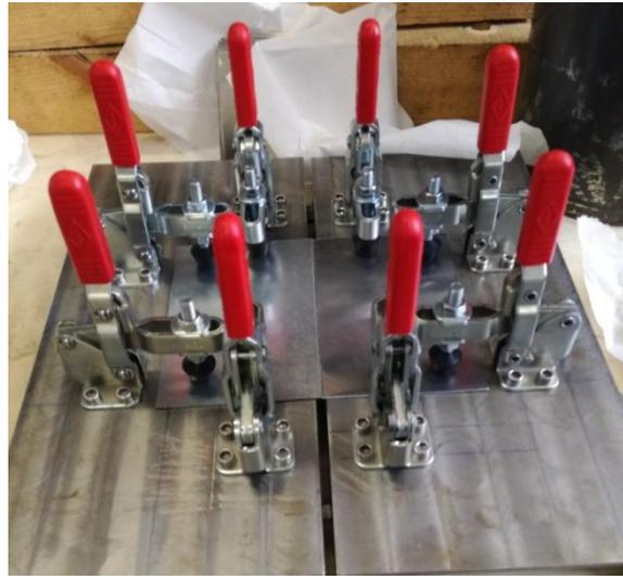
Figura nº 5. Utillaje necesario para el anclaje de los cupones a soldar.
