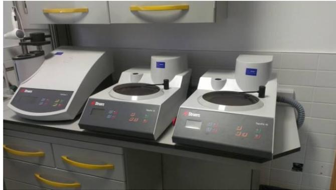
Figura nº 15. Equipos empleados en la preparación metalográfica.
