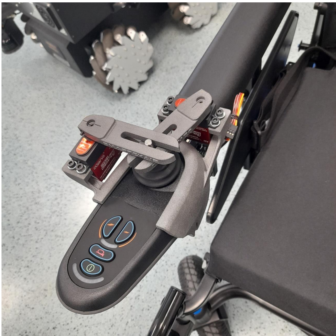
Ilustración 25. Montaje del electro mecanismo del joystick
