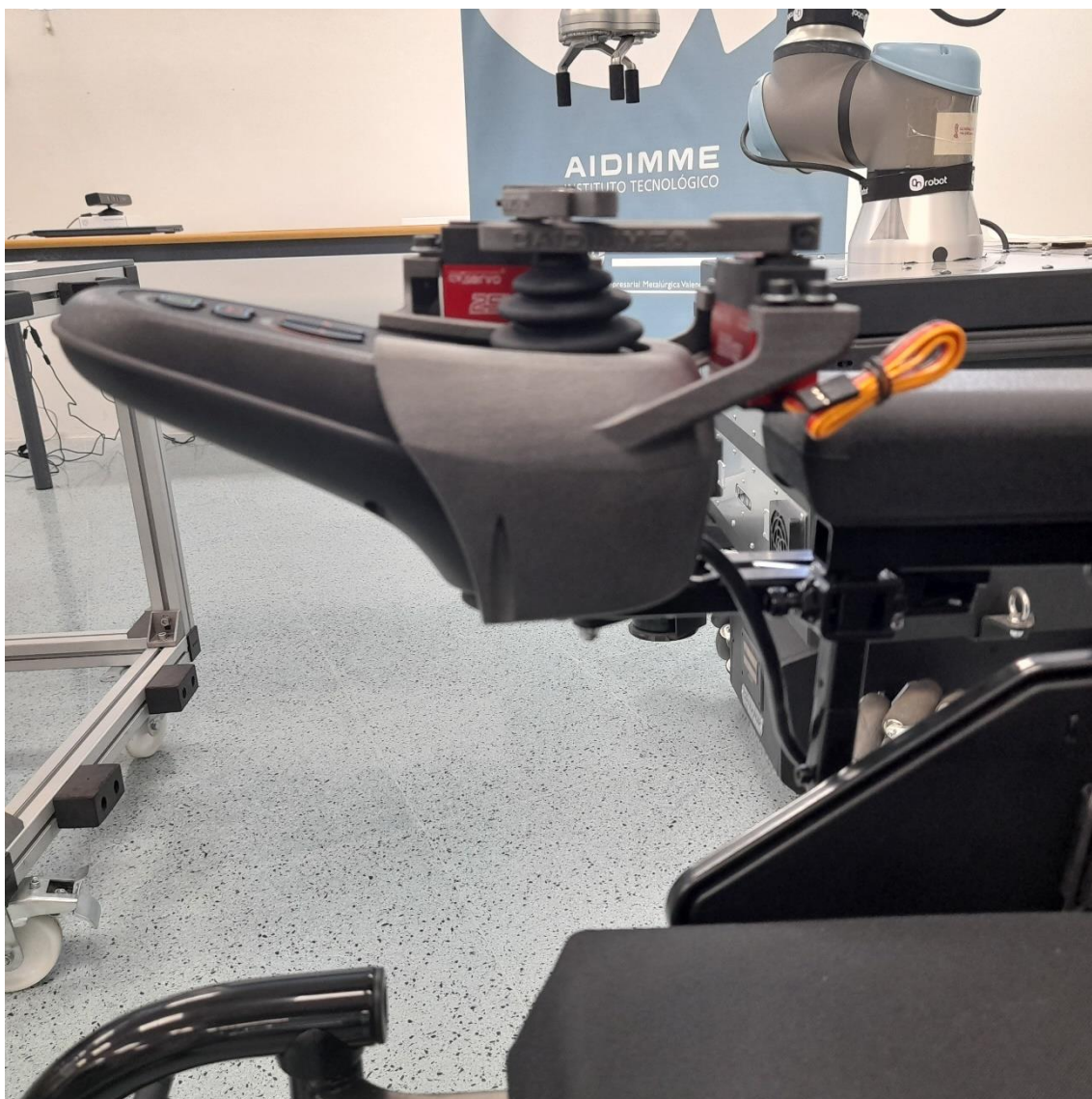
Ilustración 28. Montaje del electro mecanismo del joystick (bis)(bis)(bis)
