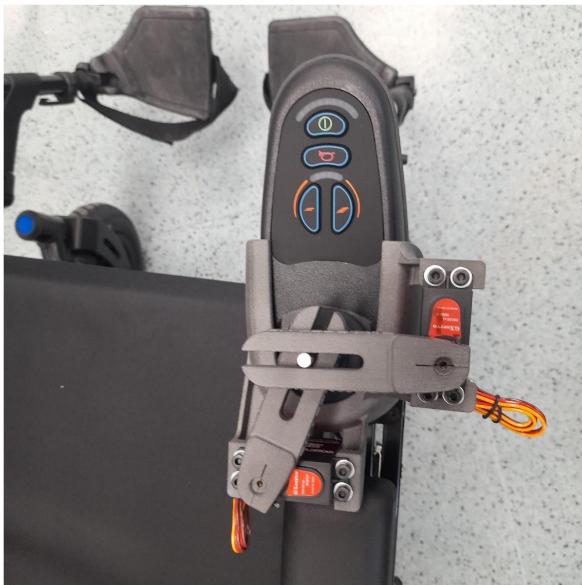
Ilustración 26. Montaje del electro mecanismo del joystick (bis)
