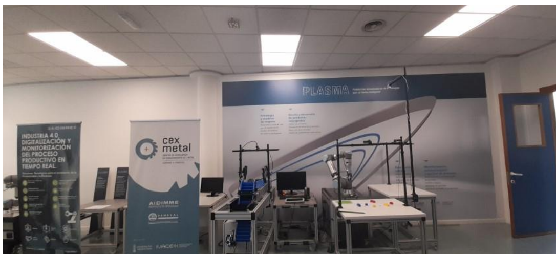
Ilustración 35. Muebles metálicos que causan interferencias por las reflexiones sobre el metal
