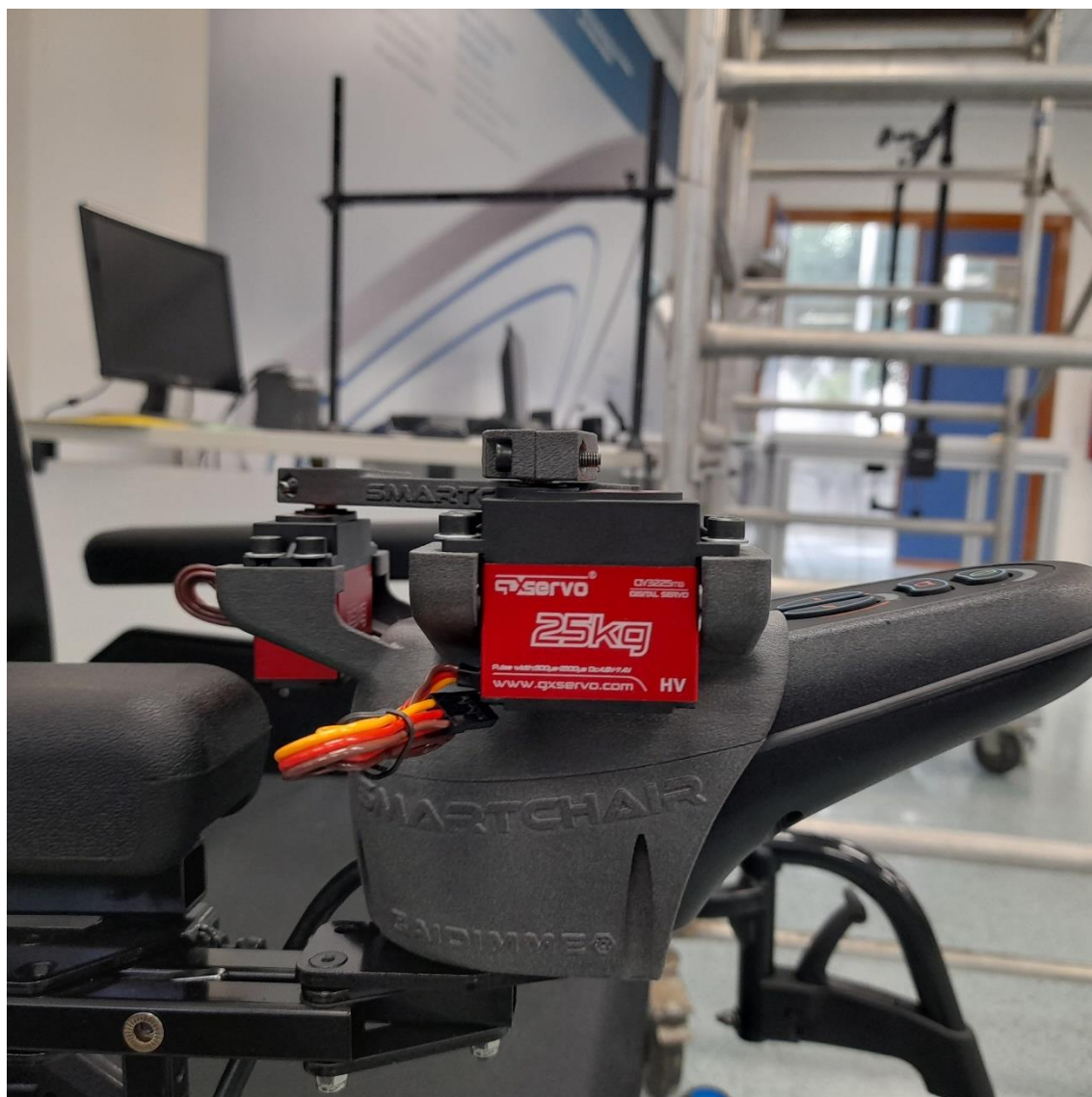
Ilustración 27. Montaje del electro mecanismo del joystick (bis)(bis)
