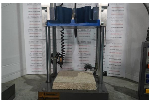
Fotografía 4. Máquina de ensayos de amortiguamiento, LANSMONT - PDT 23.
