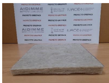
Fotografía 2. Fibra de Kenaf espesor 20 mm.
