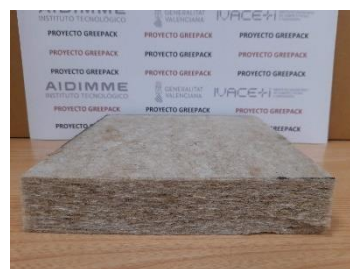
Fotografía 3. Fibra de Kenaf espesor 40 mm.
