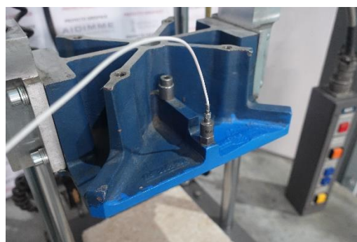
Fotografía 5. Detalle del plato y acelerómetro.
