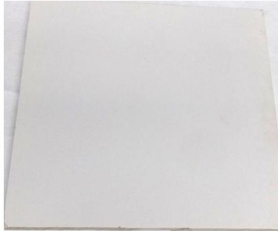
**Figura 24. Aspecto del sustrato tipo silestone utilizado para aplicar las formulaciones.**
