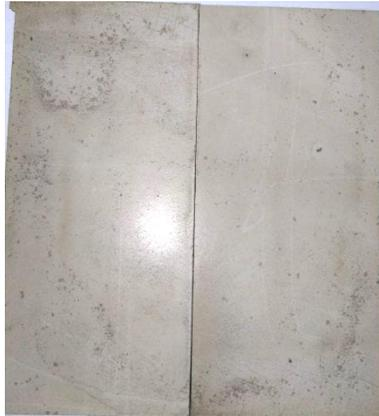
**Figura 31. Aspecto de la probeta tratada por inmersión en dopamina (PDA\_I).**
