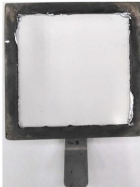
Figura 32. Sustrato insertado en el marco de retención utilizado para el ensayo del cono calorimétrico.
