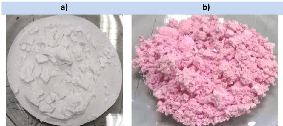
**Figura 20. Nanocápsulas preparadas en a) medio ácido (CWO2\_Ac) y b) medio básico (CWO2\_Ba) tras el secado.**
