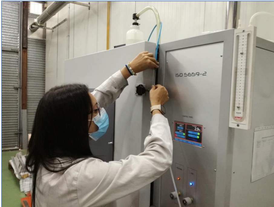
Figura 18.- Toma de muestra del humo interior de la cámara para su posterior análisis cromatográfico.
