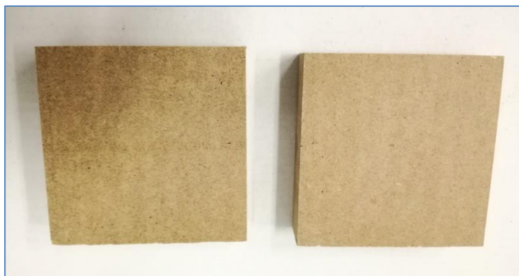
Figura 8.- Aspecto de las muestras MATTOX-04 (tablero MDF sin tratar).
