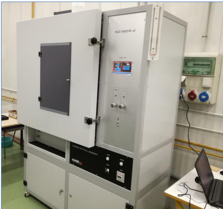
Figura 16.- Cámara de emisión de humos (smoke box).
