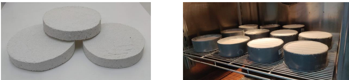
Figura 12. Preparación probetas y ensayo de permeabilidad al vapor de agua
