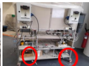
Válvulas 1 y 2 con espigas
