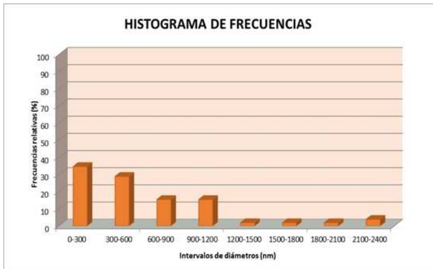
Figura 3. Histogramas de frecuencia muestra con adición de salvia (Muestra C-8S1 (90% Microfibra + 10 % Poliuretano))
