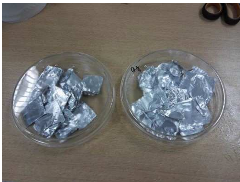
Fig.22. Probetas de textil de ensayo esterilizadas
