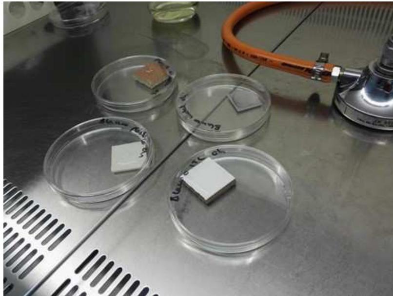
Fig.19. Muestra de las probetas de ensayo inoculadas
