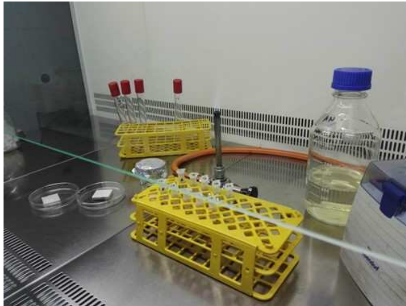
Fig. 16. Preparación de diluciones a partir del cultivo bacteriano de trabajo para conocer su concentración
