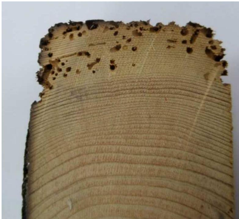
Detalle de una muestra con nivel de degradación 2 (medio).
