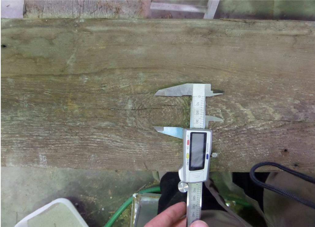
Medición de nudos en la cara de una viga. La medición de los nudos grandes forma parte de la metodología mejorada.
