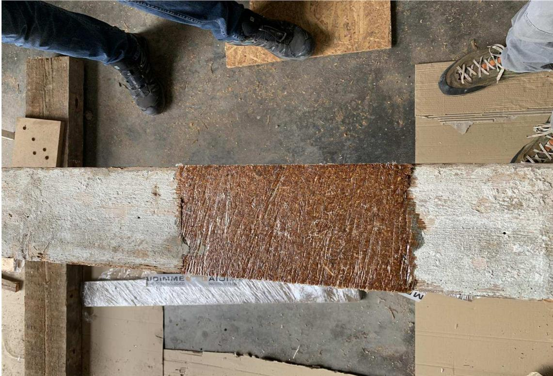
Viga reforzada/consolidada con una mezcla de resina y de serrín de madera, en lugar de árido.
