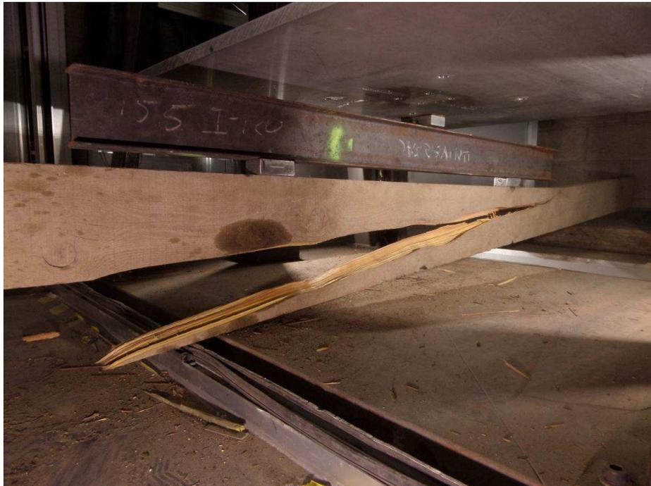
Ensayo destructivo para determinar la resistencia a flexión estática.
