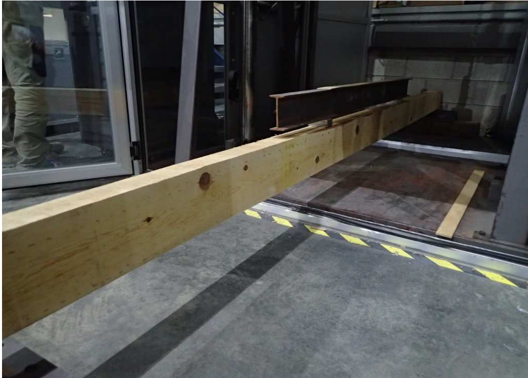
Preparación del ensayo de flexión según la norma UNE EN 408.
