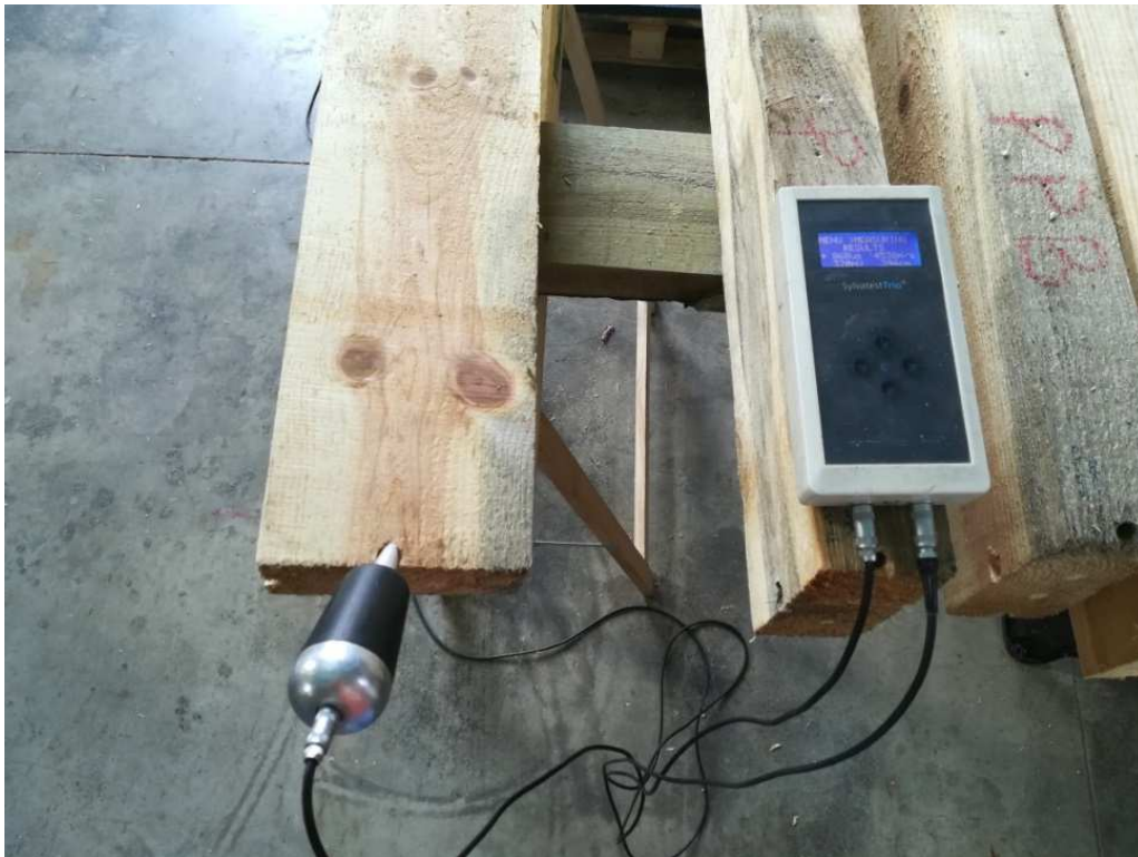
Evaluación no destructiva mediante la técnica de emisión-recepción de ultrasonidos.
