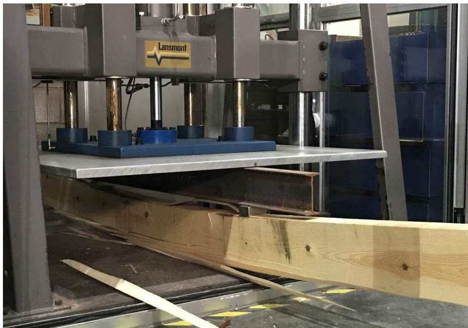
Rotura de una viga de Pinus sylvestris en el ensayo de flexión según la norma UNE EN 408.
