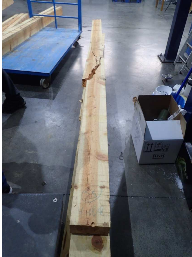
Rotura de una viga de Pinus nigra después del ensayo de flexión según la norma UNE EN 408.
