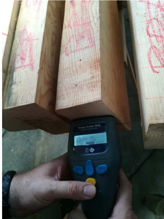
Evaluación no destructiva mediante la técnica de vibraciones inducidas/ondas de presión.
