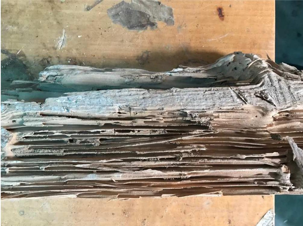
Degradación por termitas (*Reticulitermes lucifugus*) en abeto (*Picea abies*). Nótese el típico daño en forma de “hoja de libro”: las termitas abren galerías paralelas a la dirección de la fibra de la madera, entre las cuales van dejado intactas tiras delgadas, que no tienen resistencia apreciable. Fte. AIDIMME
