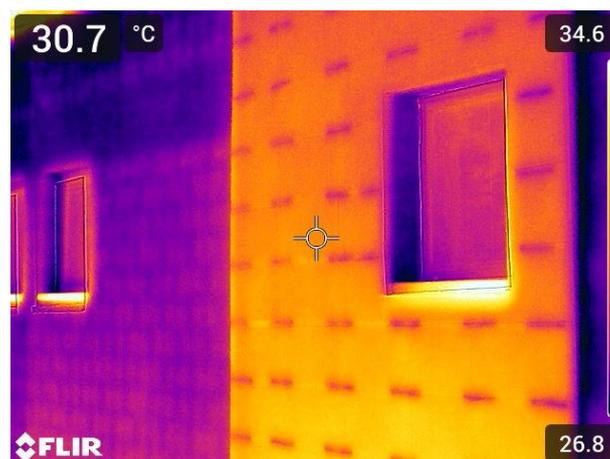
**Figura 1813.** Imagen de cámara termográfica del muro SATE. Propia
