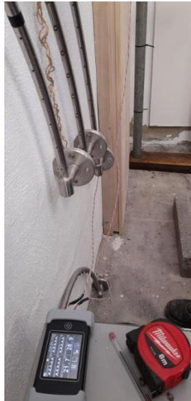
**Figura 15.** Datalogger para obtención de datos de temperatura SATI
