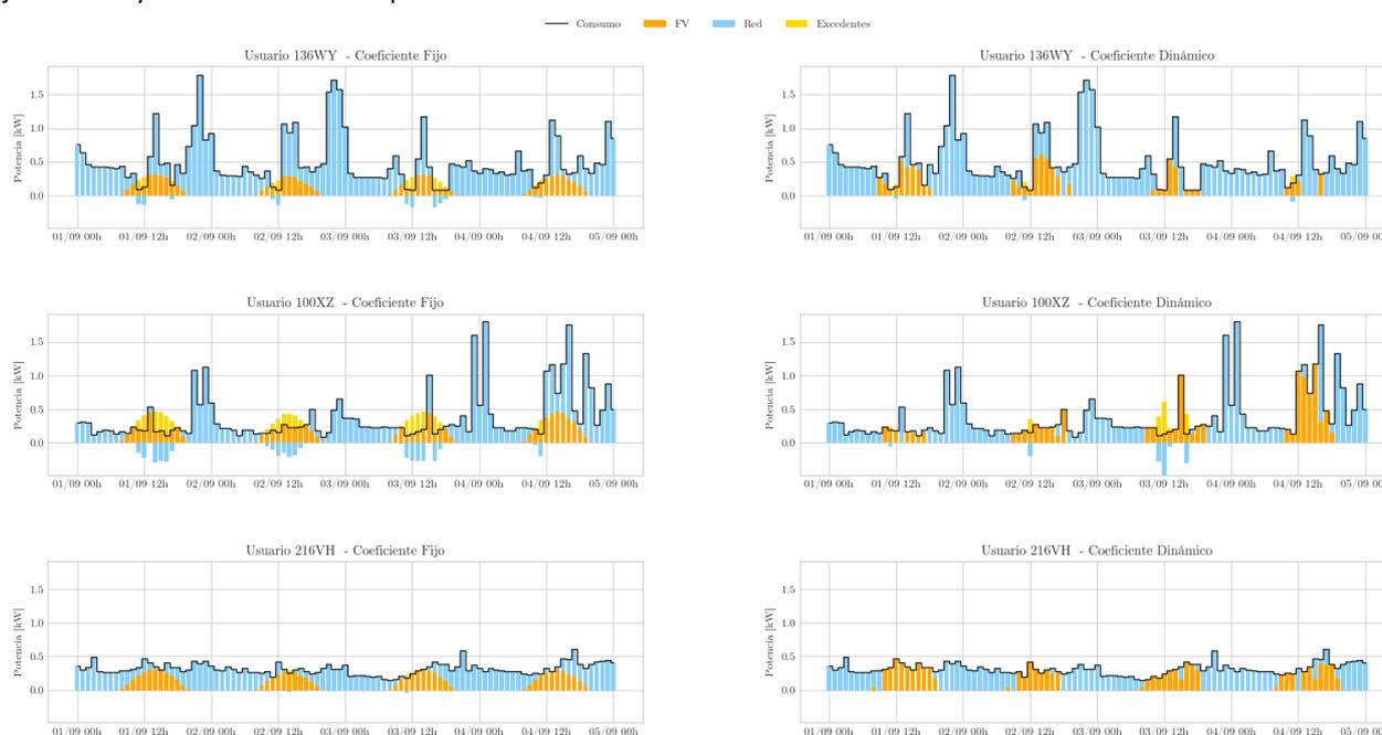
Figura muestra el perfil horario de potencias de tres suministros de la CEL. A la izquierda, el reparto fotovoltaico con coeficientes fijos y a la derecha el reparto fotovoltaico con los coeficientes de reparto dinámicos calculado por el modelo de optimización. Se muestra en azul el consumo de la red eléctrica, en naranja la energía fotovoltaica autoconsumida y en amarillo los excedentes vertidos a red. Por último, la línea negra indicada la potencia demandada en cada periodo de tiempo.
