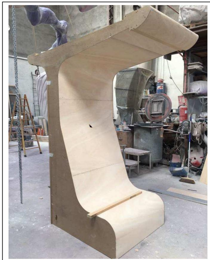
**Imagen 15. Estructura completa de madera del prototipo, desarrollada para la comprobación de medidas y que se usó como base para desarrollar el molde de la estructura.**
