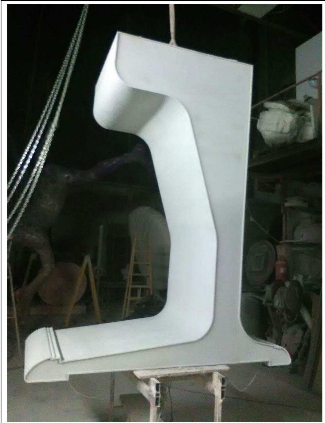
**Imagen 16. Estructura de madera del prototipo tratada y recubierta para generar el molde a partir del cual se produjo la estructura definitiva.**
