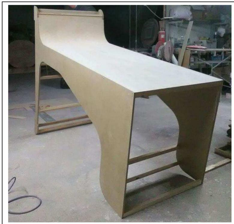
**Imagen 13. Parte de la estructura de madera del prototipo, desarrollada para la comprobación de medidas y que se usó como base para desarrollar el molde de la estructura.**
