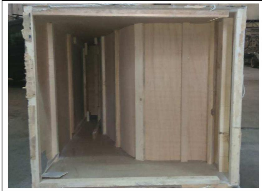
**Imagen 14. Vista interior de la estructura de madera del prototipo, desarrollada para la comprobación de medidas y que se usó como base para desarrollar el molde de la estructura.**
