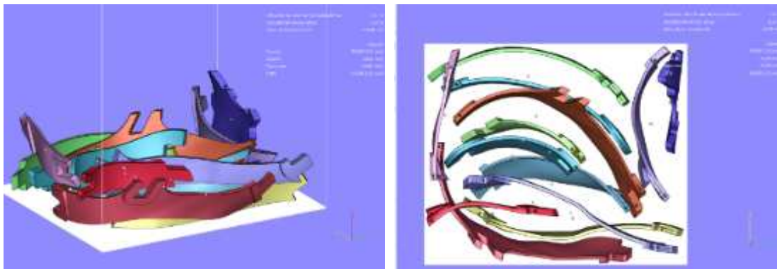
Figura 14. Preparación de la bandeja de fabricación para el corsé en 12 partes
