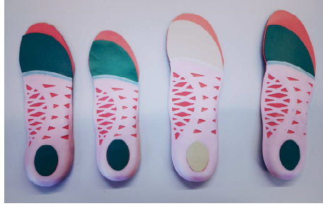
Figura 5. Modelos de plantillas a evaluar. Superior: FDM, Centro: SLS, Inferior: SLA
