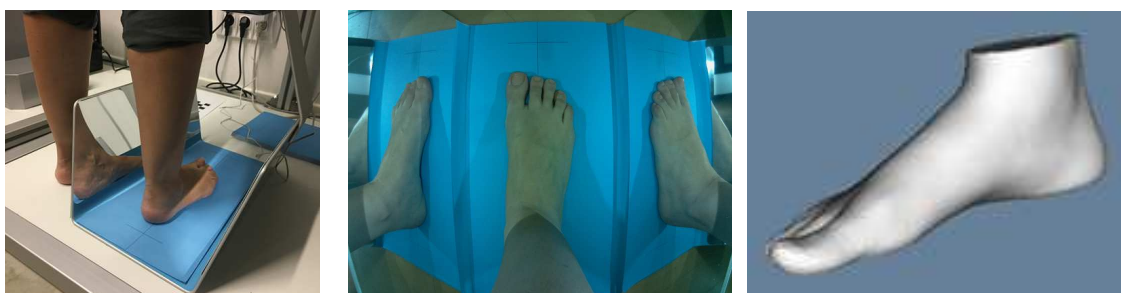
Figura 4. Obtención del avatar 3D de los pies para los ensayos
