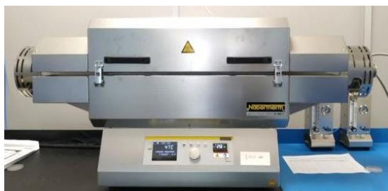
Figura 71. Horno tubular utilizado en la fundición de Cu bajo atmósfera inerte (Ar).
