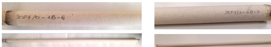
Figura 57. Membranas arcillosas utilizadas en AIDIMME para evaluar la permeabilidad en agua.
