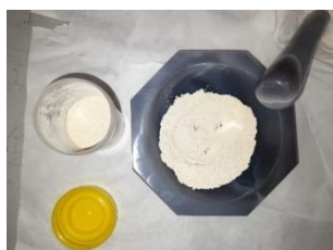
Figura 23. Molienda manual de ZnO-A3.
