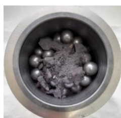
Figura 34. Tarro y bolas de WC con el CuO parcialmente oxidado a molturar.
