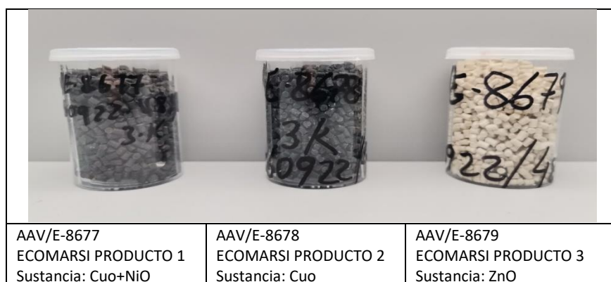
Figura 67. Muestra de los productos obtenidos en masterbatch.
