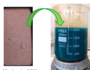
Figura 6. Polvo de Cu y baño 5_CH durante el proceso.
