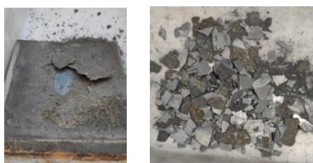
Figura 19. Láminas de Zn (Zn-A2) electrodepositado en el cátodo.
