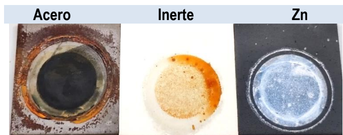
Figura 78. Aspecto de cada una de las probetas tras 35 días de exposición al agua de mar.
