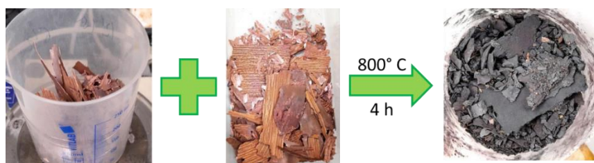
Figura 33. Aspecto del Cu antes y después de la calcinación.
