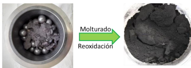
Figura 36. Aspecto de CuO-AM1 antes del molturado y después de varios procesos de oxidación y molturación.
