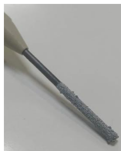
Figura 12. Electrodepósito de Zn mediante VC.
