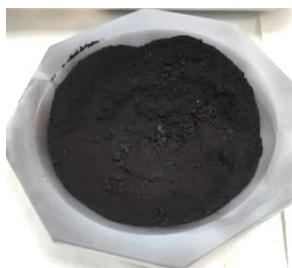
Figura 38. Lodo calcinado (CuO-AM2), molturado manualmente.
