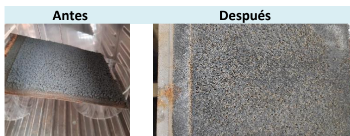
Figura 17. Cátodo de Zn con el depósito obtenido tras la ED, antes y después del secado en estufa.
