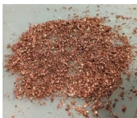
Figura 41. Cu separado del cátodo y triturado.
