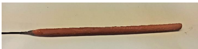
Figura 39. Cátodo recubierto de Cu electrodepositado.
