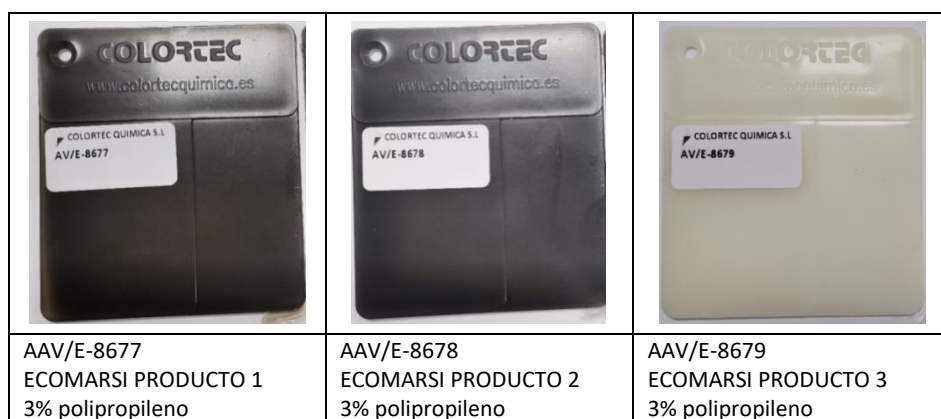
Figura 68. Muestra de los productos plásticos inyectados.
