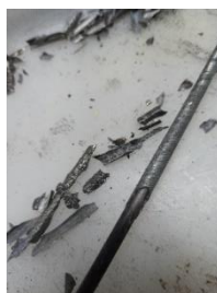
Figura 25. Separación del Zn electrodepositado del cátodo.
