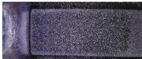
Figura 10. Aspecto del depósito de Cu obtenido en la ED del baño agotado 1_GAL.
