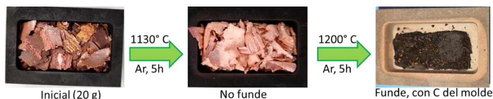
Figura 73. Aspecto del Cu inicial en el molde de grafito, y tras las diferentes etapas de fundición, hasta obtener un lingote cubierto de polvo negro.
