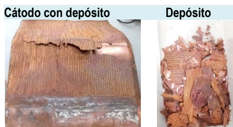
Figura 31. Cátodo de Cu tras la ED del baño 1_NG antes y después de retirar el depósito.
