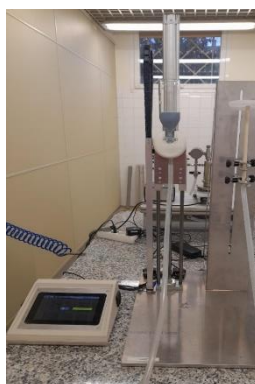
Figura 52. Dispositivo empleado para la aplicación de capas selectivas en el interior de soportes tubulares.
