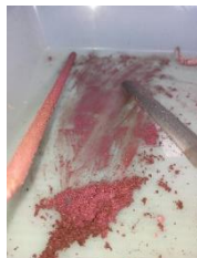
Figura 42. Separación del Cu catódico.
