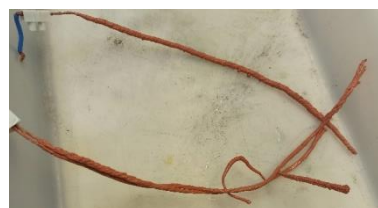
Figura 40. Cátodo 2 recubierto de Cu electrodepositado.
