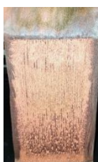
Figura 7. Aspecto del depósito de Cu obtenido en la ED del baño agotado 1_NG.
