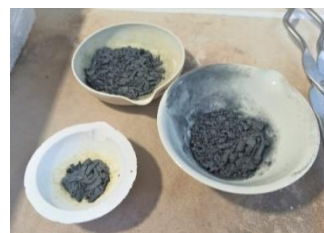
Figura 43. Primeras oxidaciones de Cu a CuO+Cu 2 O.
