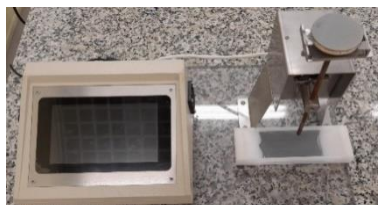
Figura 51. Dispositivo empleado para la preparación de capas sobre soportes planos.
