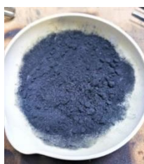
Figura 44. Oxidación completa de Cu a CuO.
