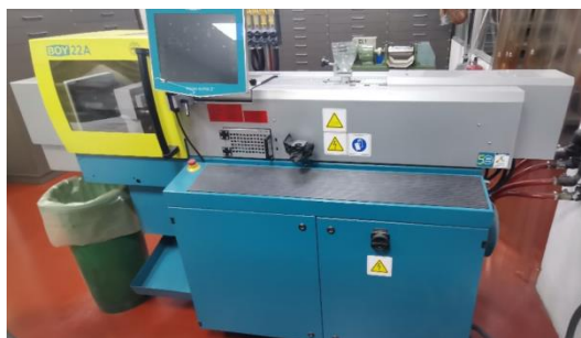
Figura 69. Equipo utilizado en el proceso de inyección.
