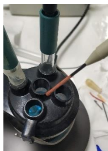
Figura 11. Electrodepósito de Cu (M6) mediante VC.
