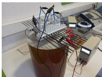
Figura 13. Depósito electroquímico (M8) con ánodo cilíndrico y de óxido metálico mixto (MMO o DSA) y cátodos cilíndricos de FC).
