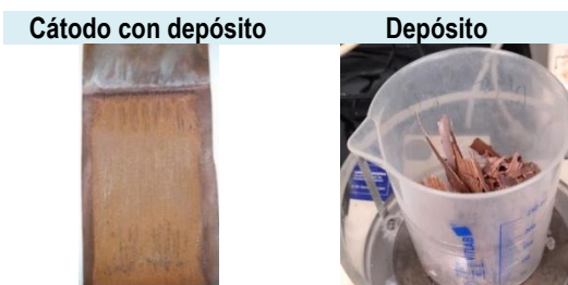
Figura 32. Cátodo de Cu con el depósito tras la ED del baño 5_CH y aspecto del depósito tras retirarlo.
