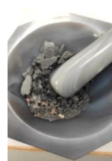
Figura 35. CuO parcialmente oxidado molido manualmente en mortero de ágata.
