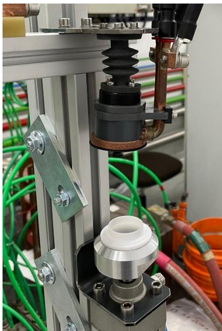
Ilustración 19. Ventosa fabricada en Flexa Performance, tecnología SLS
