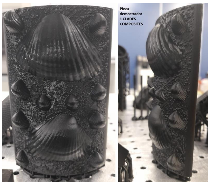
Ilustración 28. Pieza demostrador de empresa CLADES COMPOSITES en bandeja de fabricación fabricadas verticales.
