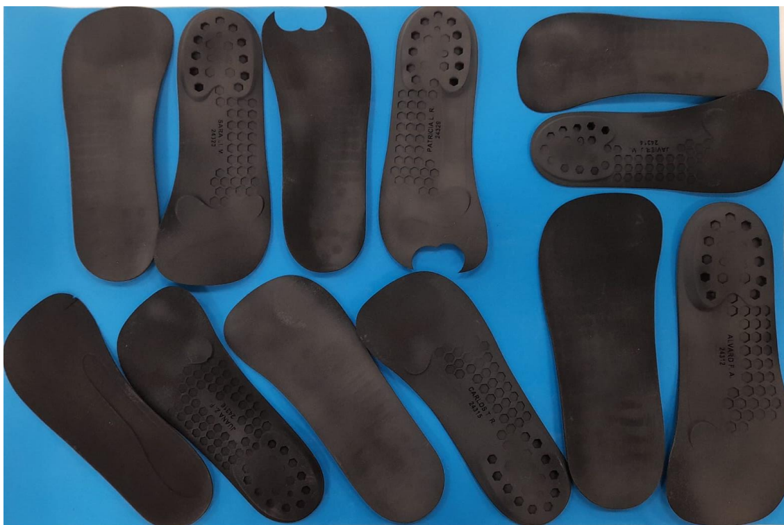
Ilustración 26. Plantilla obtenidas en una bandeja de fabricación ( 6 pares), donde se ven algunas con defectos.
