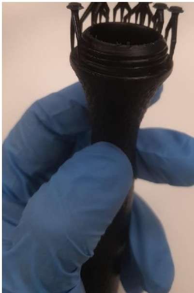
Ilustración 24. Mango de pistola con soportes mejorados y después de quitar los soportes, tecnología LCD, resina HARD.
