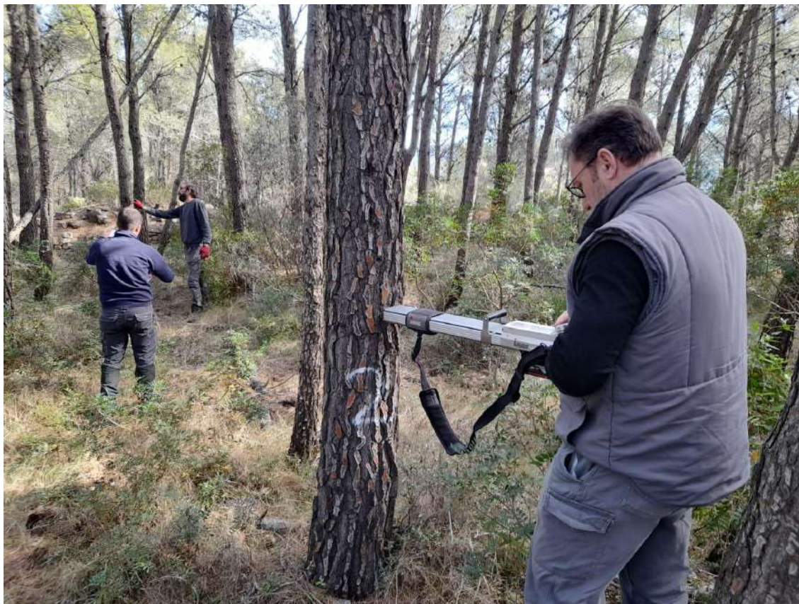
Figura 231. Resistografía de pies seleccionados 1,3 m de altura.
