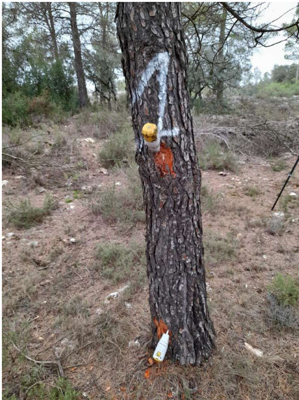
Figura 263. Ensayo de emisión y recepción de ultrasonidos sobre en el árbol 1 de la parcela 21.
