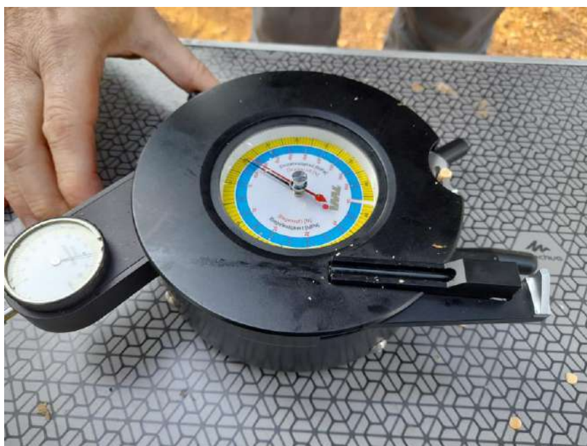
Figura 201. Medición de la compresión del árbol 7
