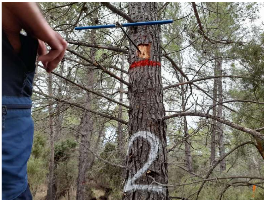
Figura 191. Barrena de pressler en árbol 2
