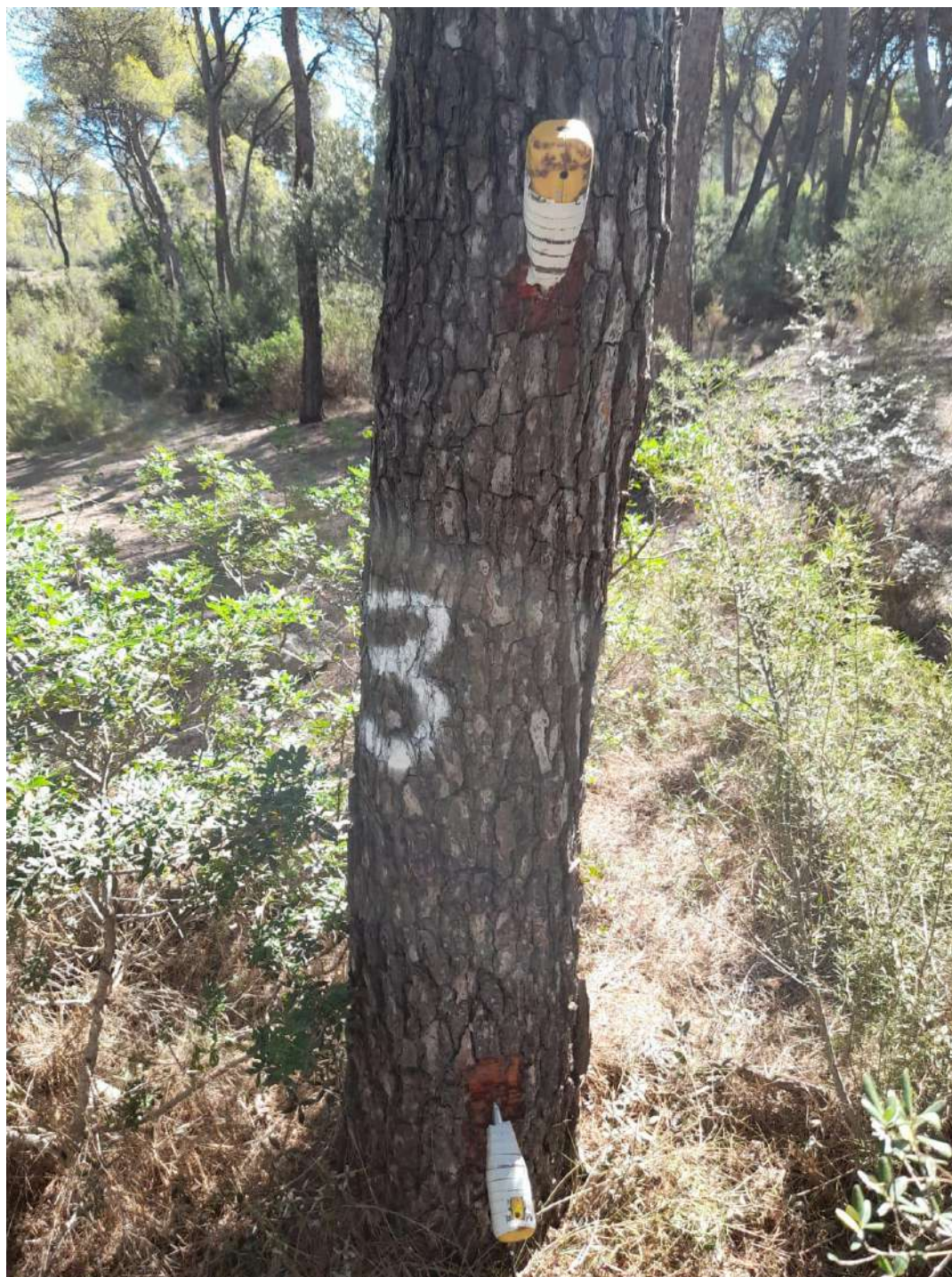
Figura 264. Ensayo de emisión y recepción de ultrasonidos sobre en el árbol 3 de la parcela 18.
