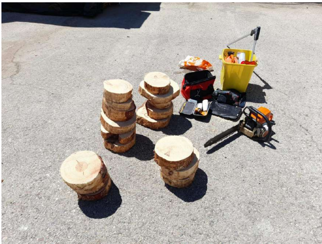
Figura 145. Rodajas cortadas de las muestras para determinar la densidad.
