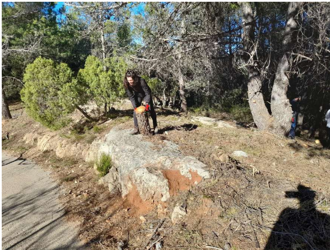
Figura 189. Extracción de uno de los troncos recién cortados para obtener la densidad
