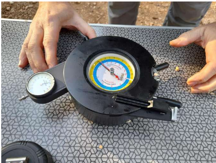
Figura 200. Medición de la compresión del árbol 4
