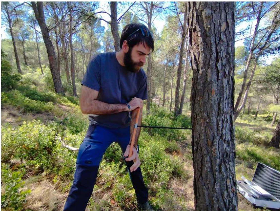
Figura 228. Barrenado de pies seleccionados con barrena pressler.
