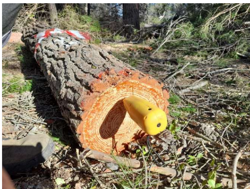
Figura 185. Medición directa con Sylvatest en árbol 21
