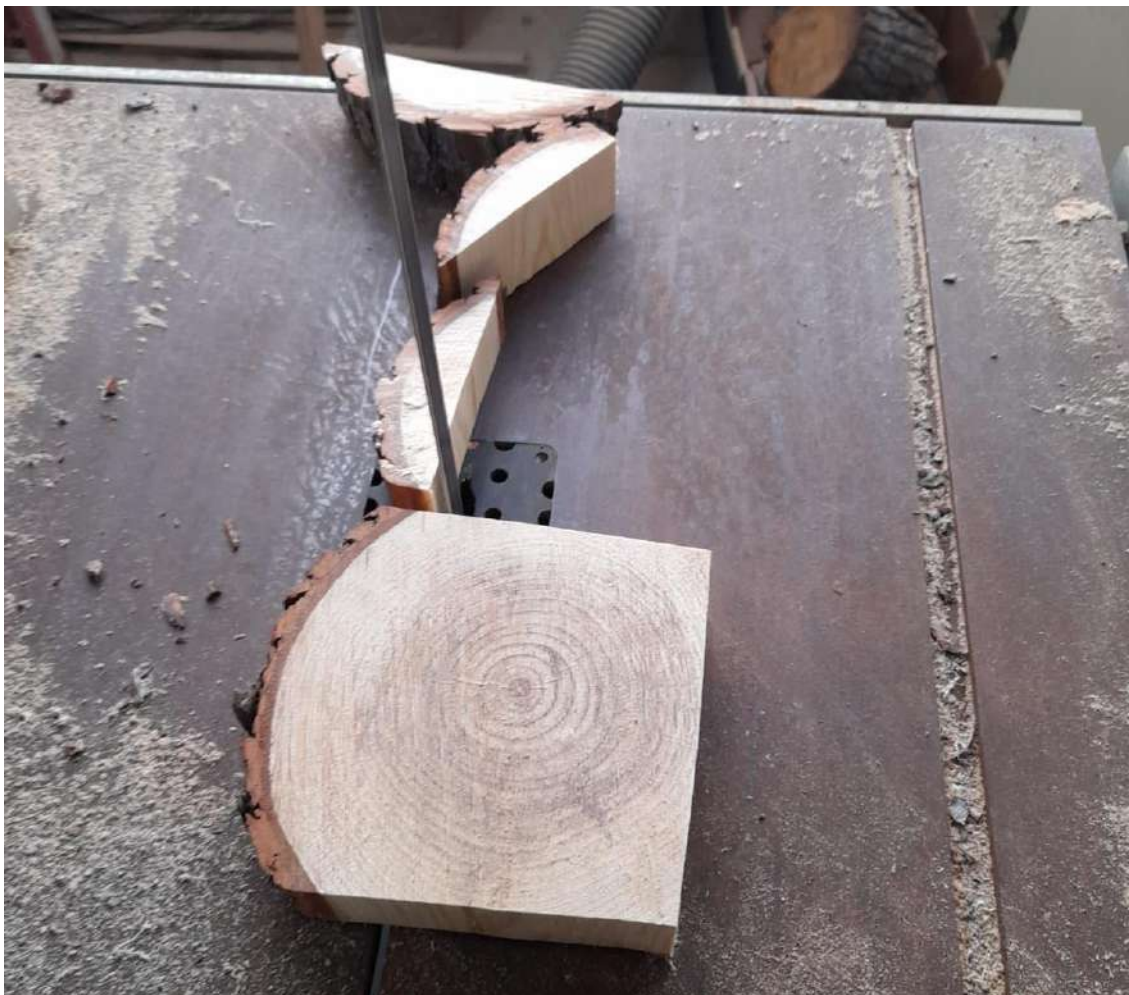
Figura 190. Recorte de rodaja para la obtención de la densidad
