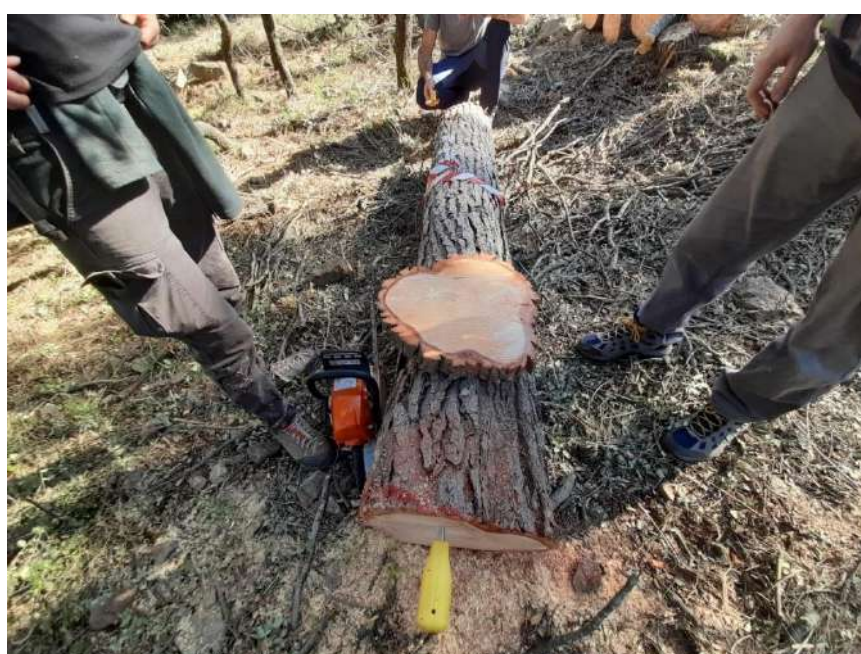
Figura 183. Medición directa con Sylvatest en árbol 13
