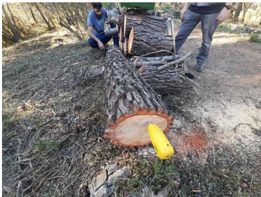
Figura 182. Medición directa con Sylvatest en árbol 12
