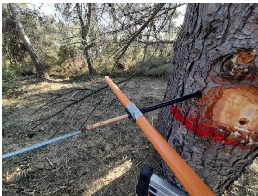
Figura 193. Barrena de pressler en árbol 8 donde se ve la extracción del tubillón
