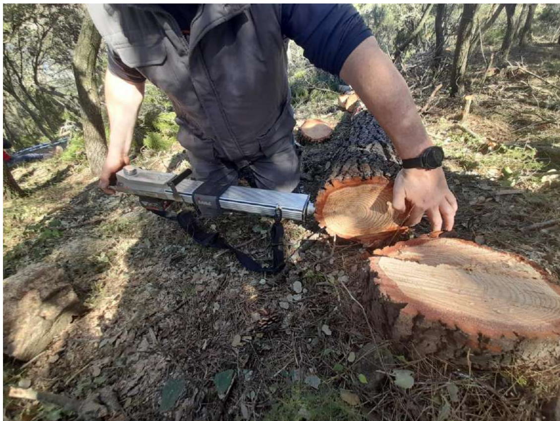
Figura 203. Resistografía en árbol 15
