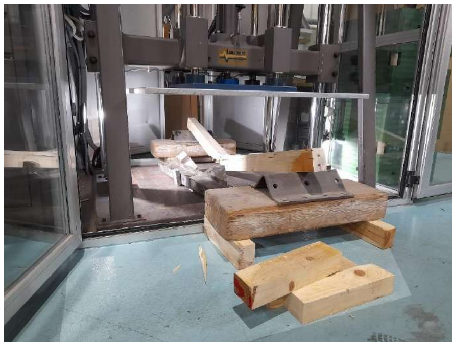
Figura 284. Rotura de viguetas de Ain e Incofusta.
