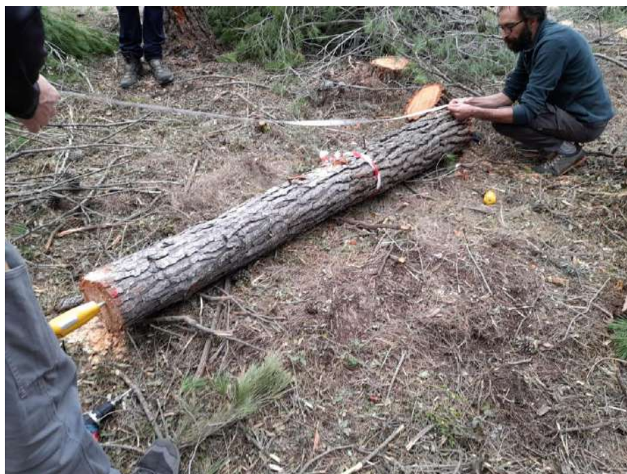
Figura 187. Medición directa con Sylvatest en árbol 24
