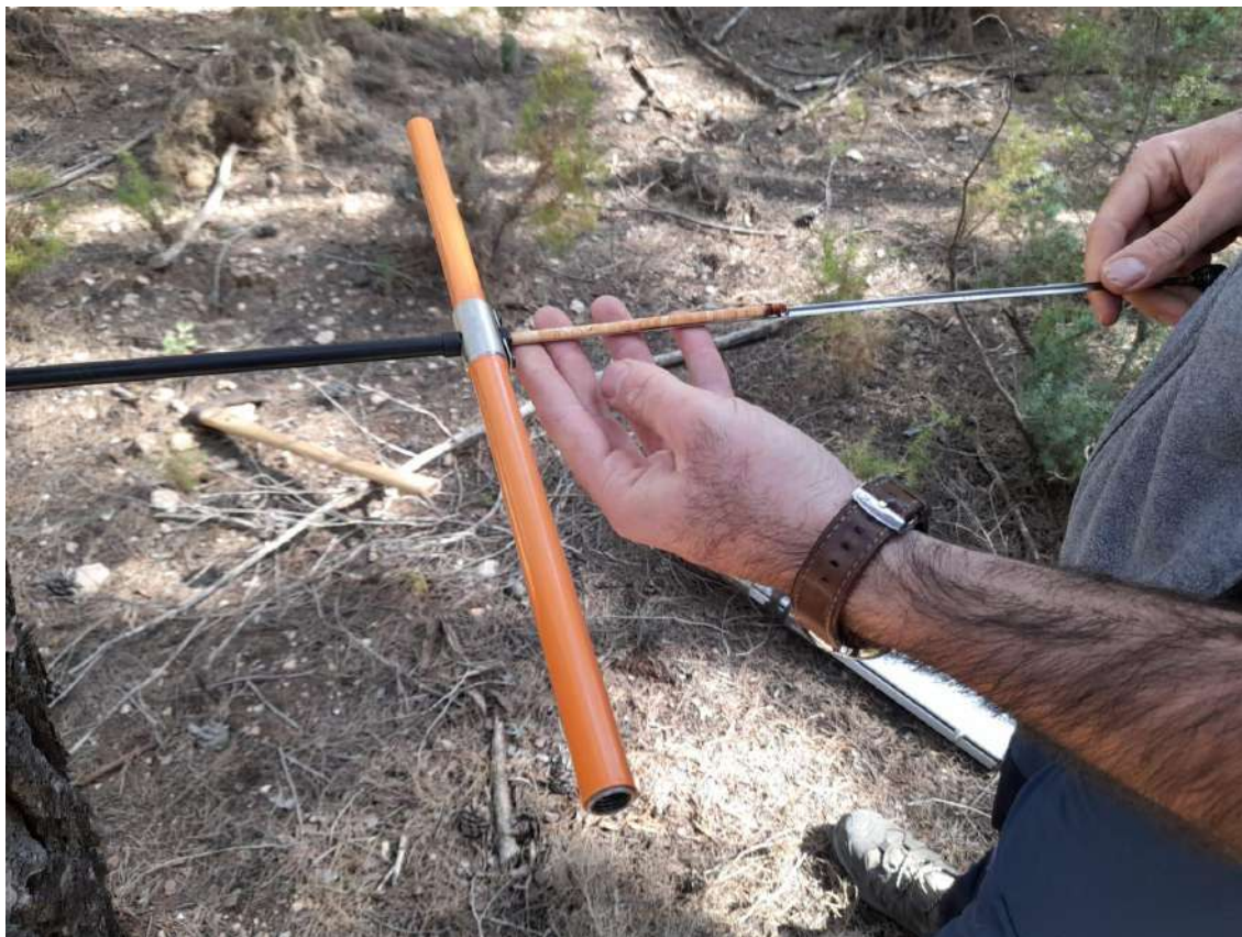
Figura 229. Extracción de la muestra realizada con la barrena.
