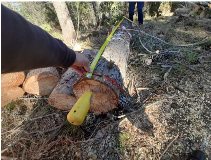
Figura 184. Medición directa con Sylvatest en árbol 17
