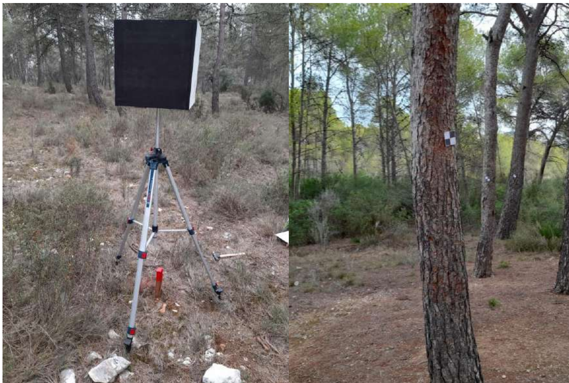
Figura 253. Centro de la parcela, cajón de referencia y dianas.
