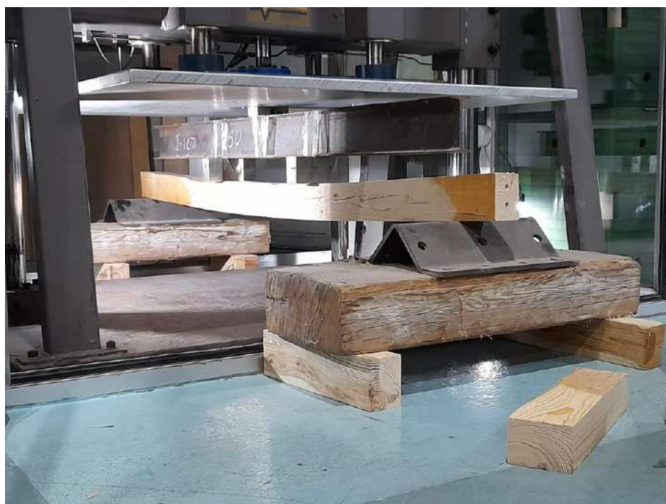
Figura 282. Ensayo a rotura sobre las viguetas de Ain e Incofusta.
