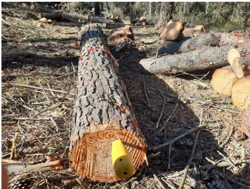
Figura 186. Medición directa con Sylvatest en árbol 23
