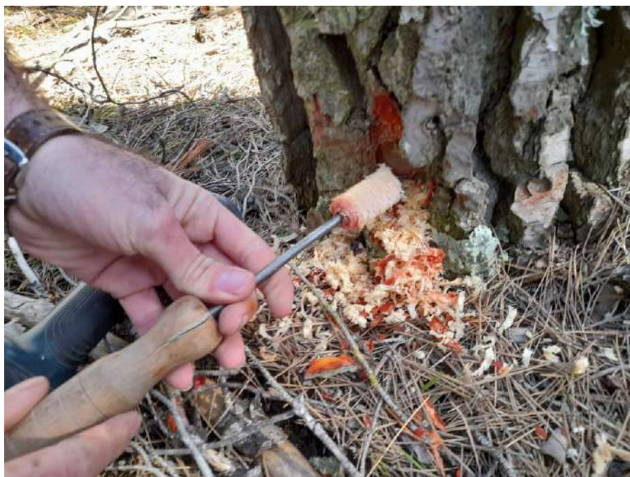
Figura 225. Extracción de la muestra en la parcela 6 con el punzón
