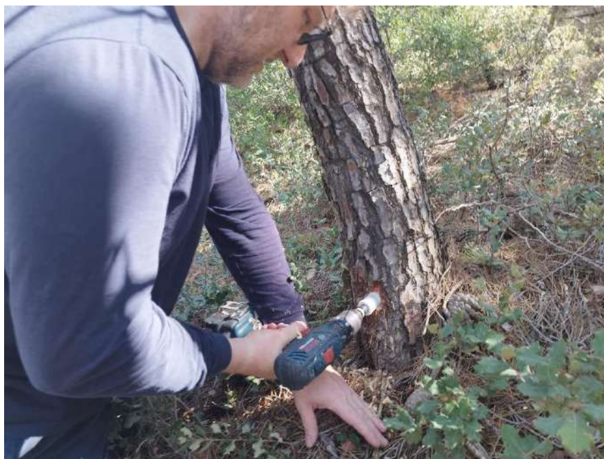
Figura 227. Extracción para muestra de densidad en parcela 14
