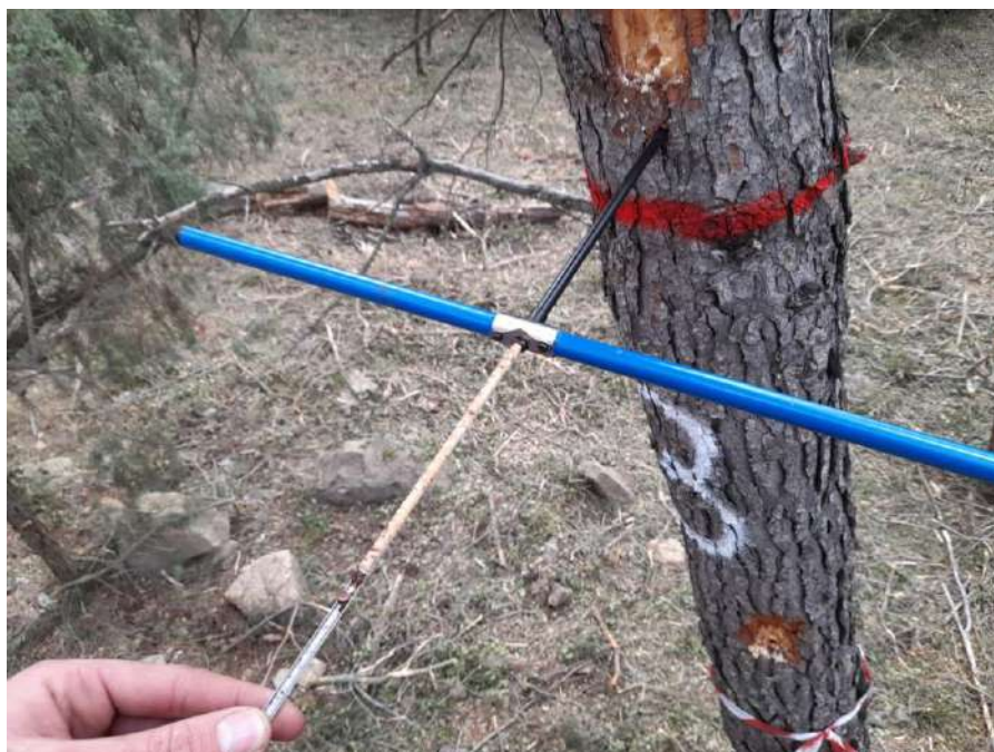
Figura 192. Barrena de pressler en árbol 3 donde se ve la extracción del tubillón
