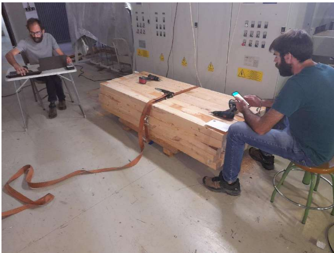
Figura 280. Retestado de vigas a longitud de 2 metros.
