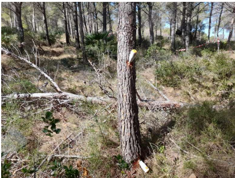
Figura 221. Medición de ultrasonidos en el pino 2.2. de Castellón
