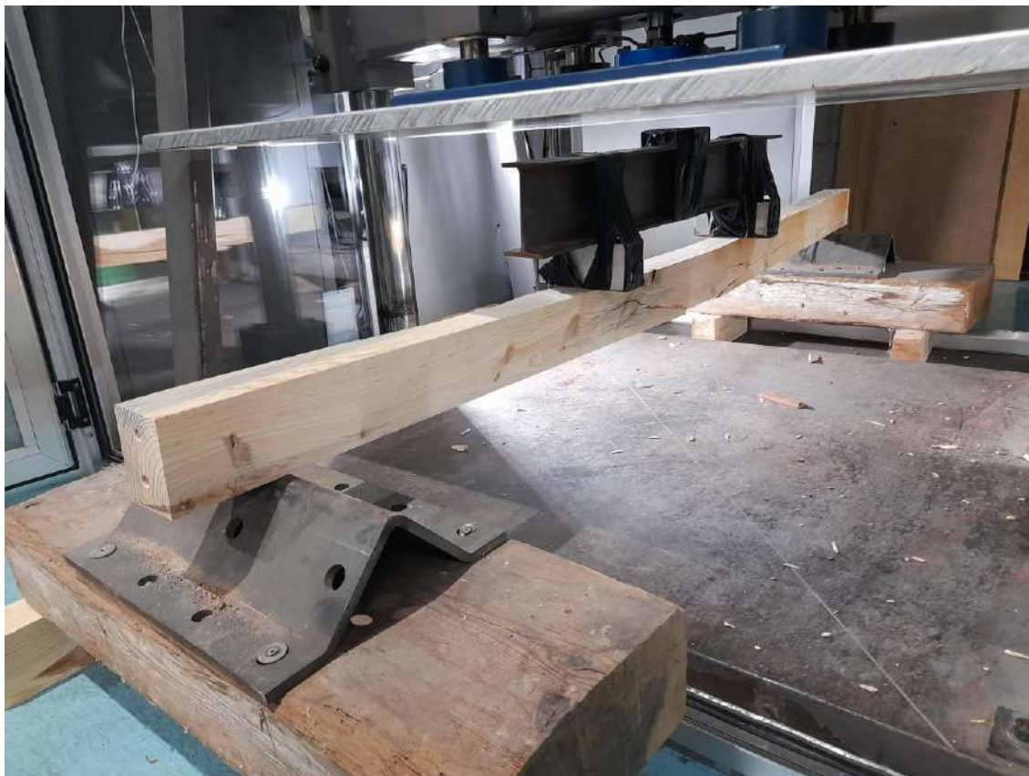
Figura 283. Ensayo a rotura sobre las viguetas de Ain e Incofusta.
