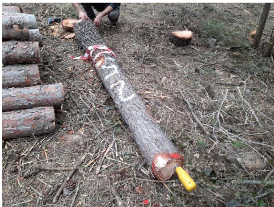
Figura 188. Medición directa con Sylvatest en árbol 25
