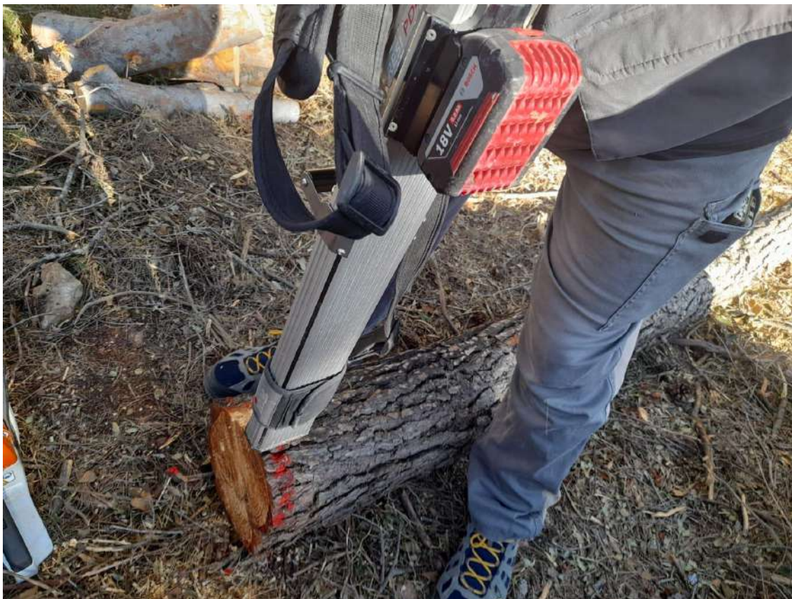
Figura 204. Resistografía en árbol 25
