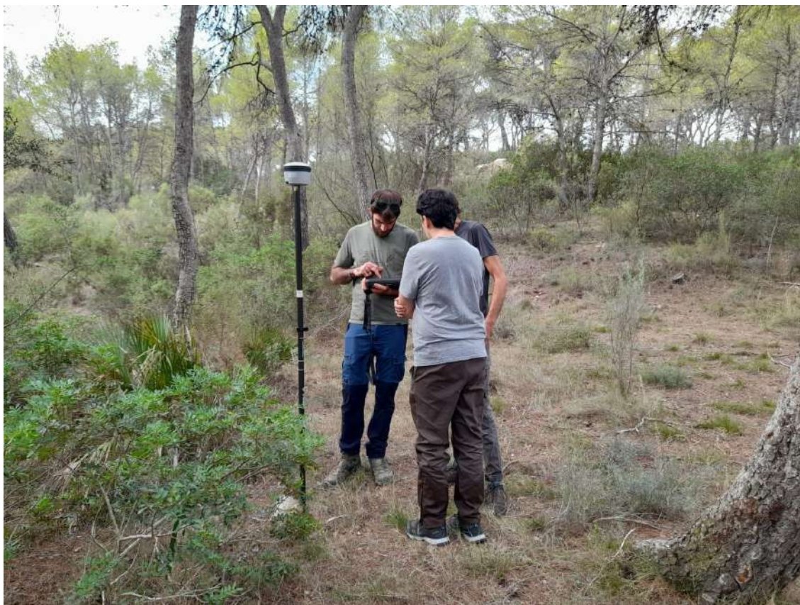
Figura 250. Marcado del centro de la parcela con GPS de precisión. Parcela 18.
