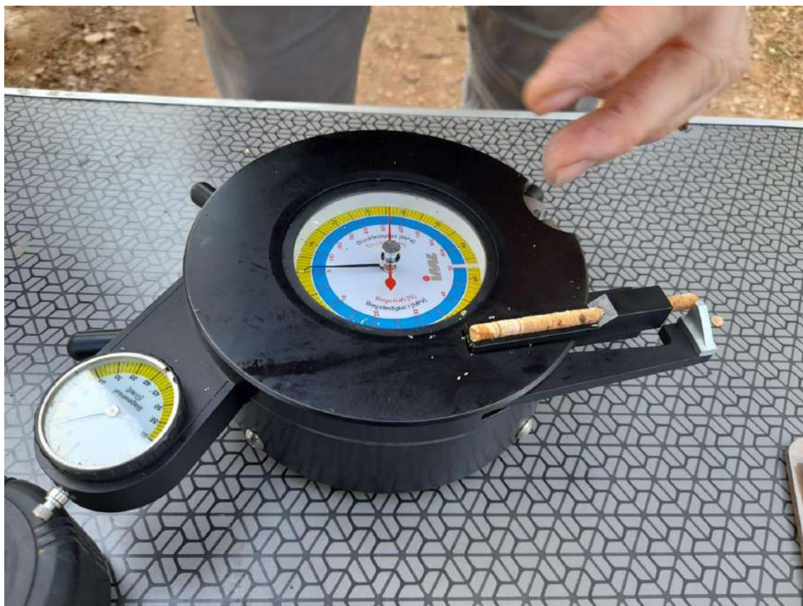
Figura 198. Medición de la flexión (medida 3/5) en el árbol 6
