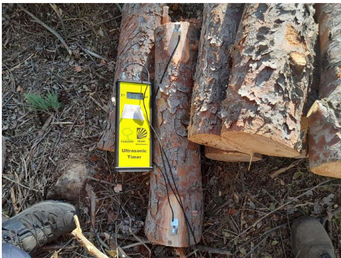
Figura 202. Prueba de Fakopp en madera verde
