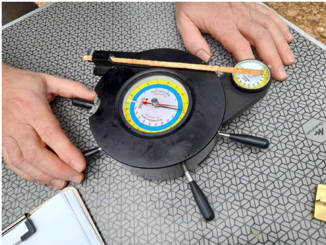
Figura 197. Medición de la flexión con fractómetro del árbol 2
